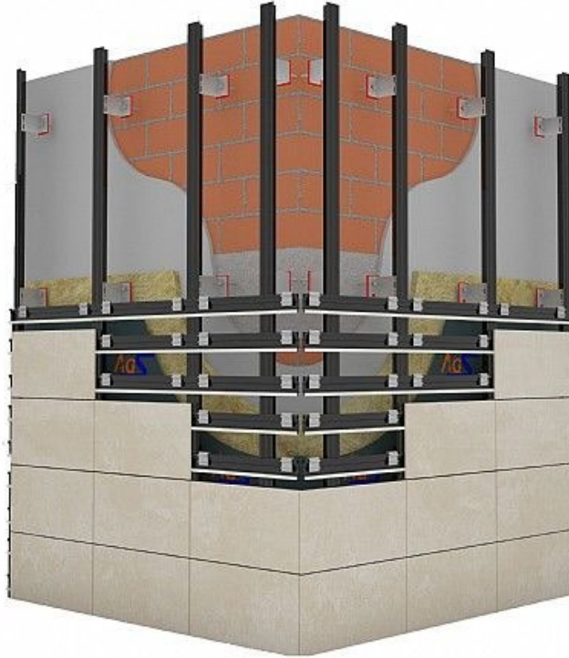
Şekil 2. 31: Havalandırılmalı cephe vidalı sistem bileşenleri ilişkileri [43].
