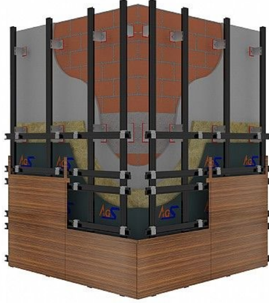
Şekil 2. 32: Havalandırılmal cephe agraflı sistem bileşenleri [40].
