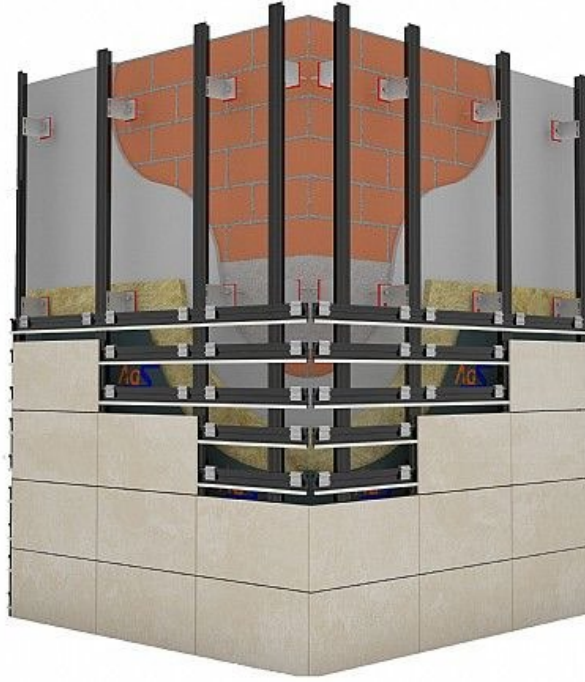
řekil 2. 25: Havalandırılmalı cephe klipsli sistem bileřenleri iliřkileri [70].
