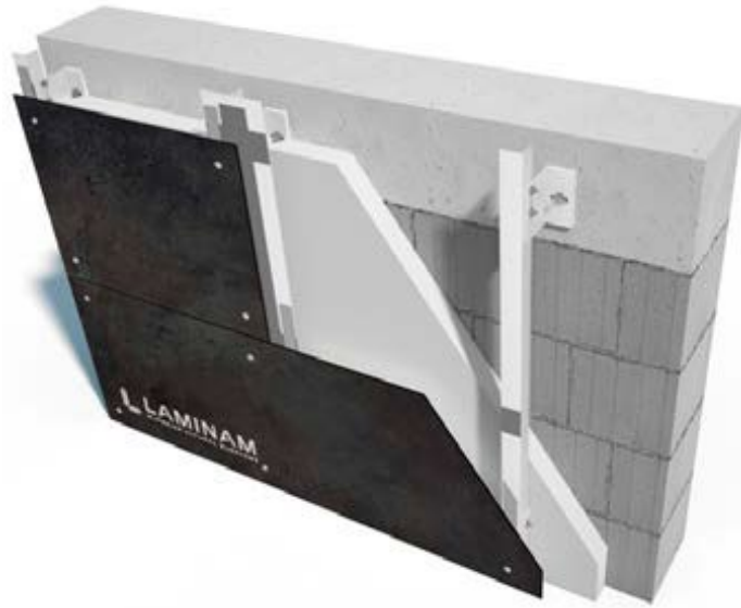
Şekil 2. 28: Havalandırılmalı cephe vidalı sistem bileşenleri ilişkileri [75].
