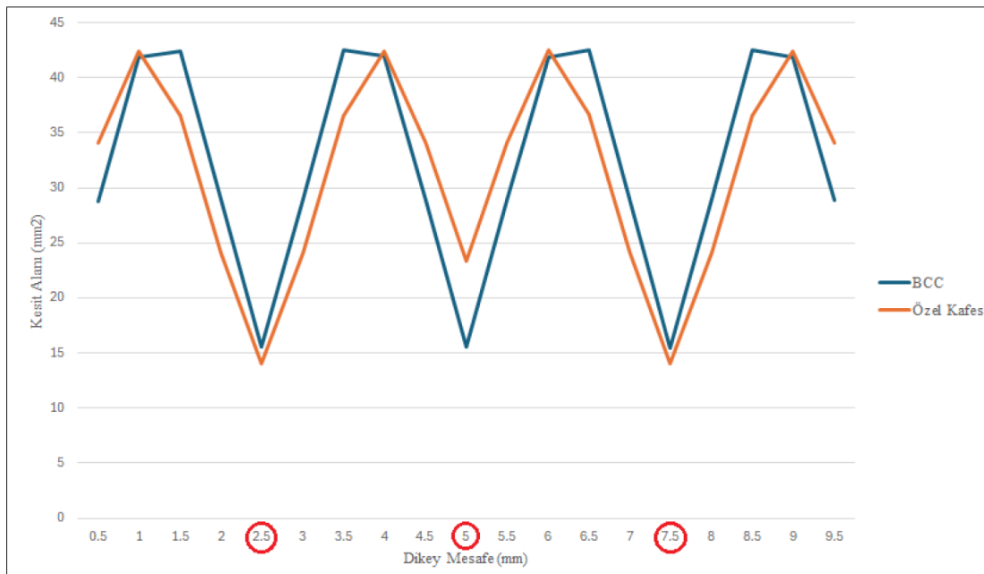
Şekil 4.19. BCC ve özel kafes yapısının kesit alanlarının karşılaştırılması
