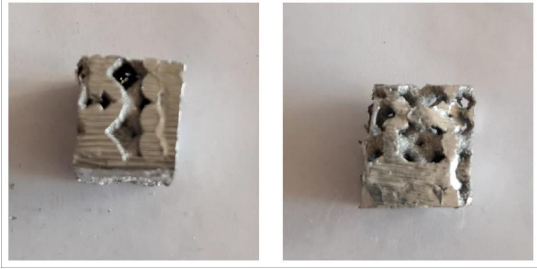
Şekil 3.22. Kademeli özel ve kademeli Truncated Octahedron kafes yapılarının infiltrasyon sonucu
