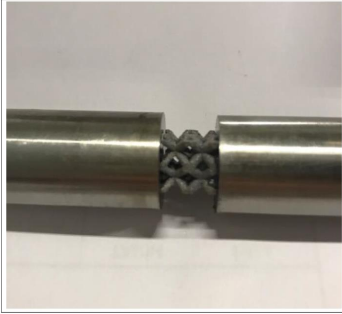
Şekil 3. 24. Giriş ve çıkış çubuğu arasına yerleştirilen test parçası
