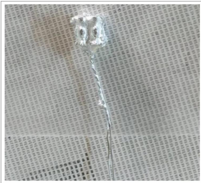
Şekil 3.21. İnfiltrasyon işlemi sonucu oluşan ikinci aşama
