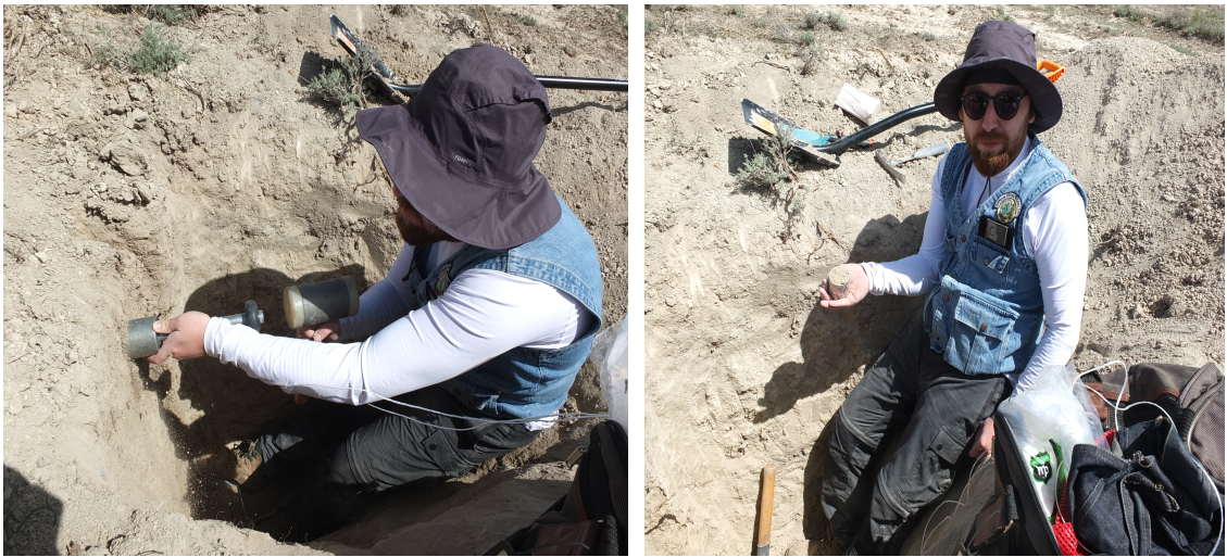
Şekil 2.14. Çalışma alanlarında kazılan profil çukurlarındaki bozulmamış toprak hacim ağırlığı örneklemeleri.
