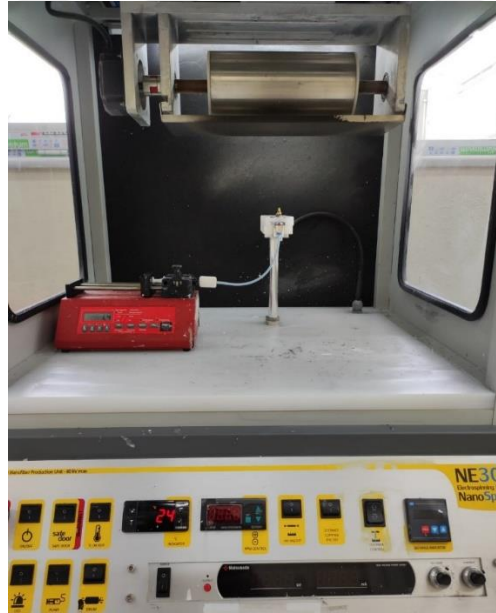
Şekil 3.1. Çalışmada kullanılan elektro çekim düzeneği
