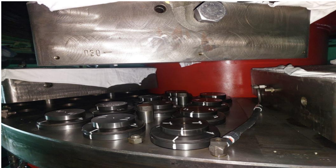
Şekil 4.3. Rehabilitasyon öncesi lokma askıdayken pimlerin görünümü
