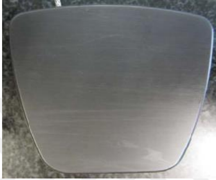
Şekil 3.5. PEEK taşıyıcı yatak lokma pedi [13]
