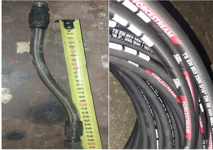
Şekil 4.2. Rehabilitasyon öncesi keten hortum ile rehabilitasyon sonrası kauçuk hortum
