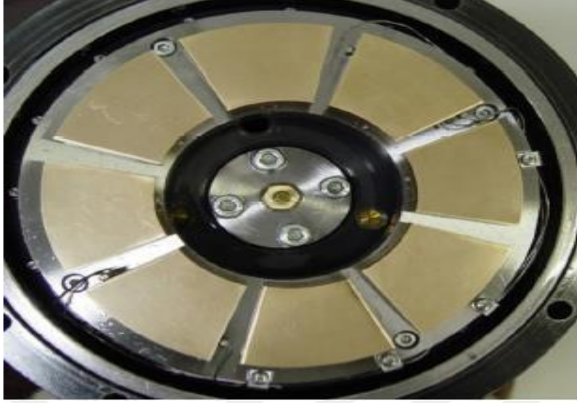
Şekil 3.7. Bronz/Çelik taşıyıcı yatak lokma pedi [29]
