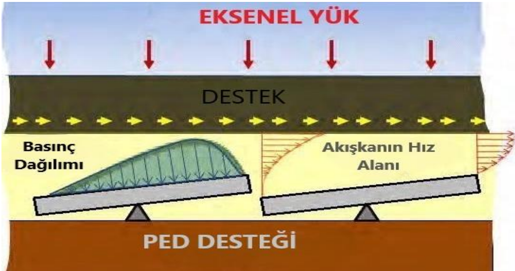
Şekil 3.10. Taşıyıcı yatak lokma pedinin eksenel yük altında performans şeması
