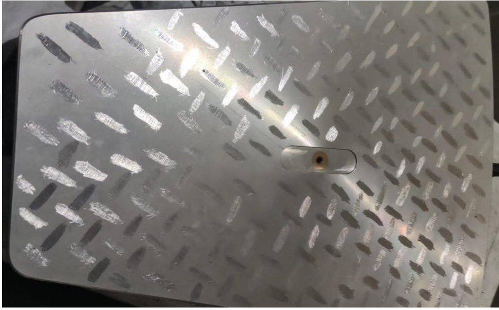
Şekil 3.8. Taşıyıcı yatak lokma pedi beyaz metal görünümü
