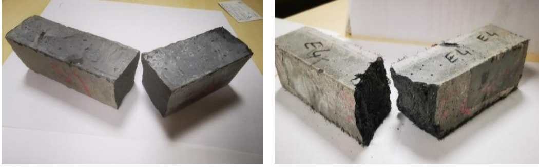
Şekil 3.40: Lifsiz ve %4 numunelerin eğilme deneyi sonucu kırılma şekilleri.
