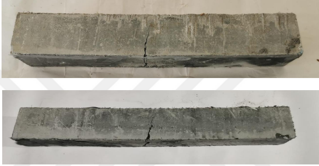
Şekil 3.40: Lifsiz ve %4 numunelerin eğilme deneyi sonucu kırılma şekilleri.
