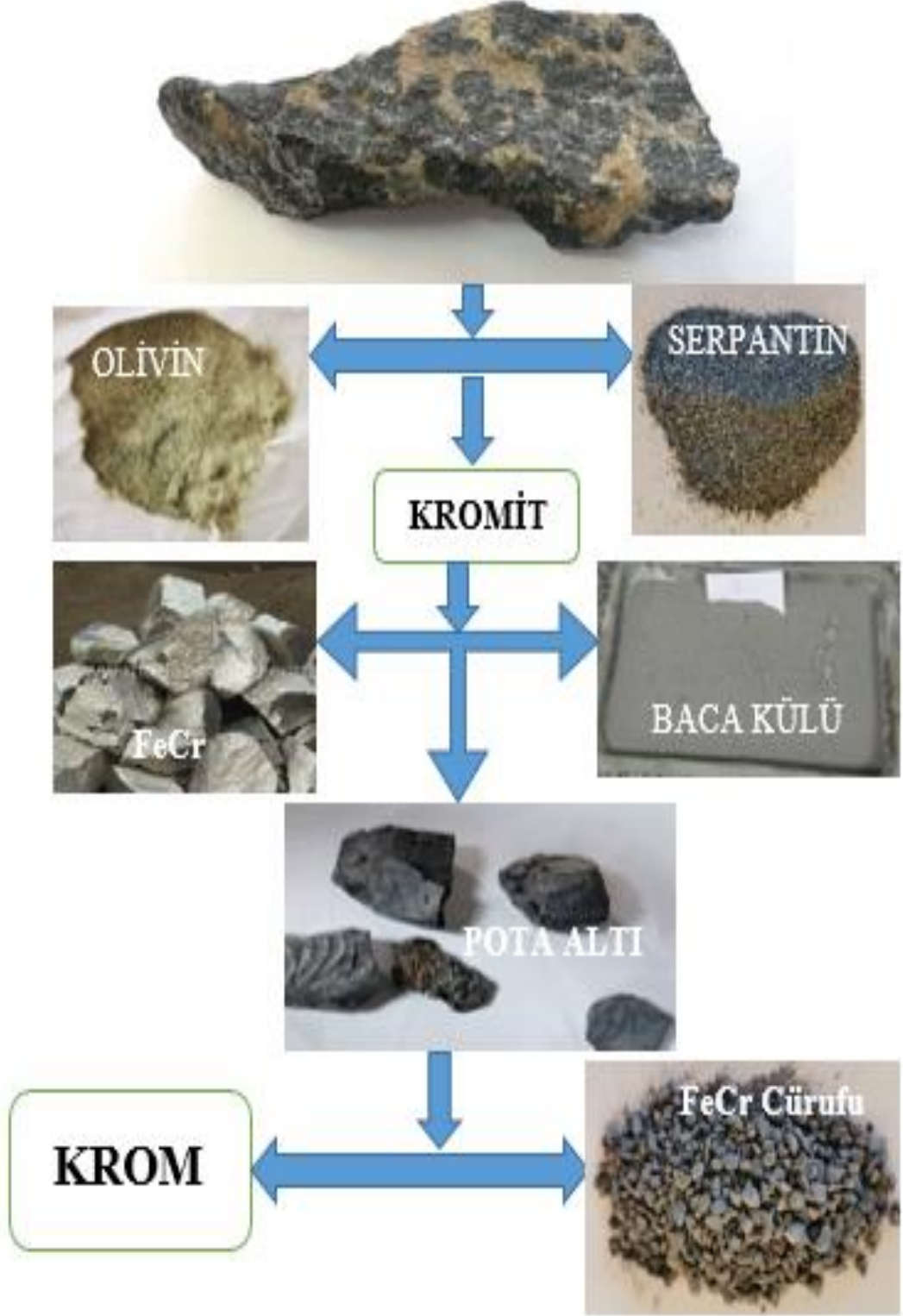
Şekil 3.6 : Ferrokrom cüruflarının oluşum süreci.
