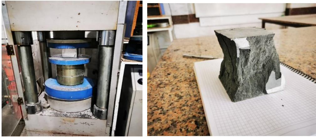
Şekil 4.1 : Basınç dayanım test düzeneği ve referans kırılmış numune resmi.
