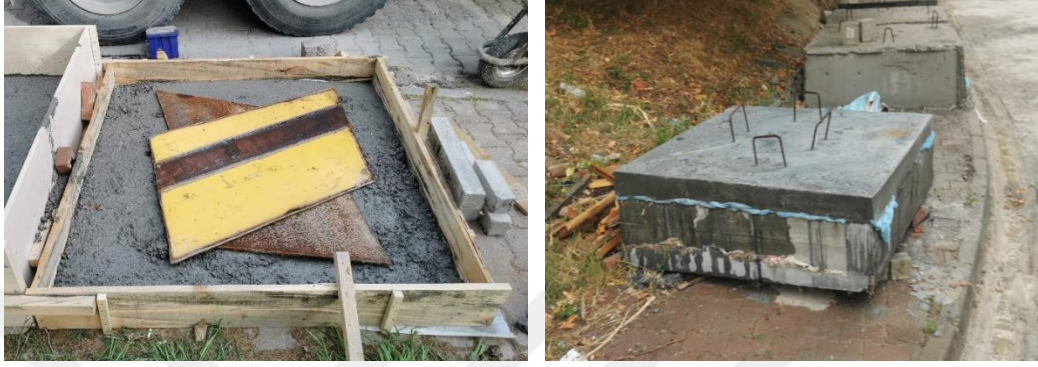
Şekil 3.37 : GRPC Betonarme + ÖTL Lif (%4)+ Zırh (2 cm), (GRPC4W-Z) içeren numune üretimi
