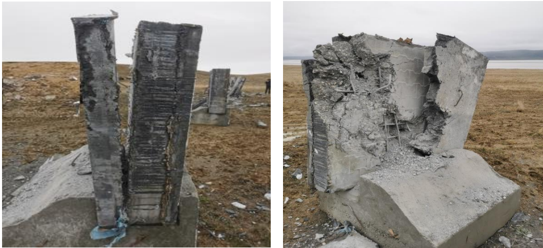
Şekil 4.25: Kompozit Betonunun (GRPC+C40+GRPC) atış sonrası görünümü
