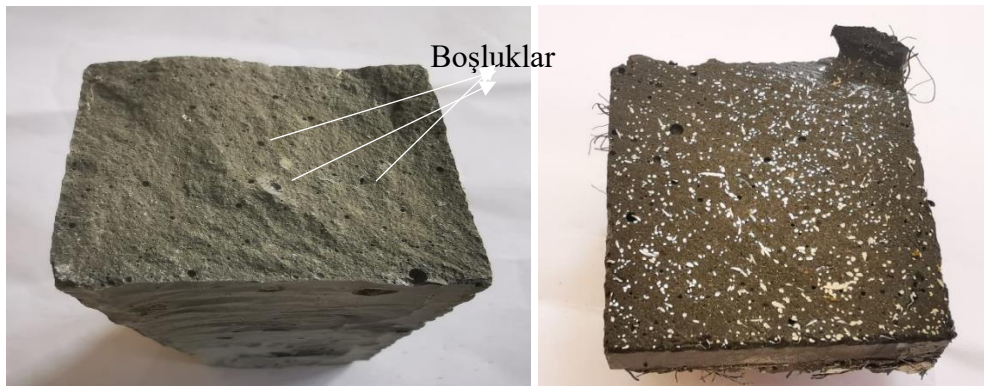
Şekil 4.5. Eğilme dayanım deneyi sonucu kırılmış Referans (lifsiz) ve lifli kesilmiş numune kesit.
