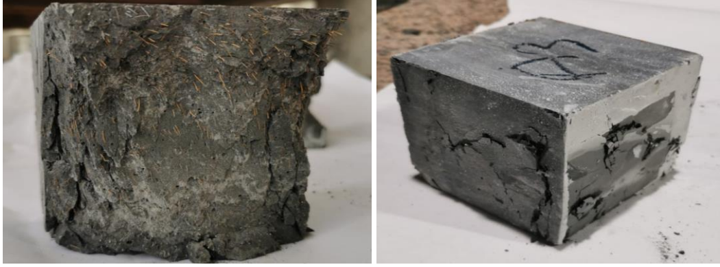
Şekil 4.3. Endüstriyel ve ÖTL lifli numunelerin basınç dayanım test sonrası görünümü.
