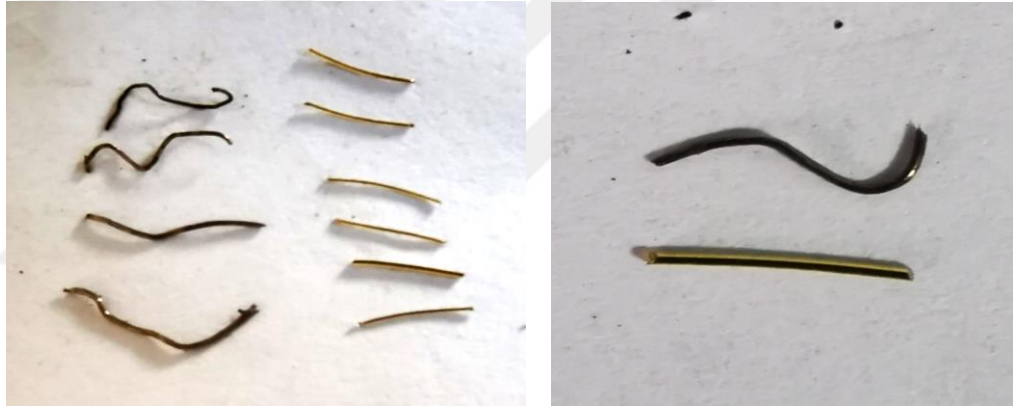
Şekil 3.15 : ÖTL Liflerinin ayrışma boyutları
