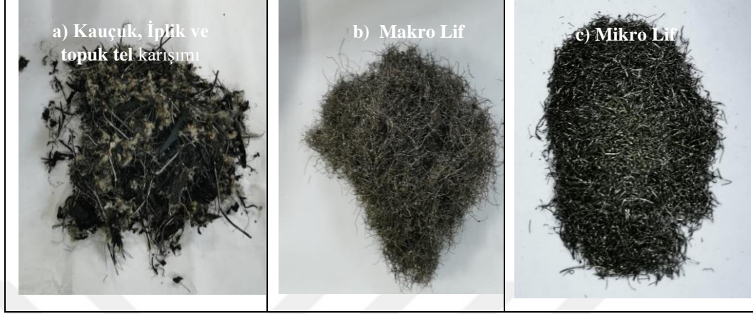
Şekil 3.15 : ÖTL Liflerinin ayrışma boyutları
