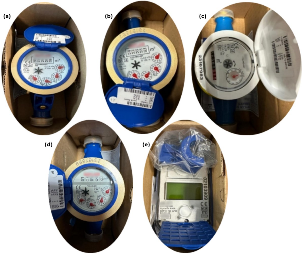
Şekil 3.3. Test edilen su sayaçlarına ait görseller a) Çok hüzmeli R100; b) Çok hüzmeli R160; c) Çok hüzmeli R200; d) Volümetrik R200; e) Ultrasonik R400
