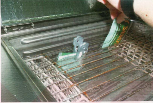
Şekil 3.2.1.4 45°C sıcaklıkta saf su bulunan su banyosuna alüminyum folyo paketlerin ikili gruplar halinde yerleştirilmesi.
