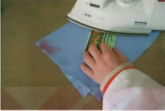
Şekil 3.2.1.3 İçinde 1 nolu tohum partisinin 1. tekerrürü bulunan alüminyum folyo paketin ısı ile kapatılması.
