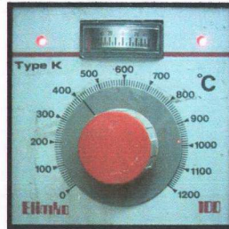
Cam Füzyon fırınında kullanılan Analog ısı göstere cihazı
