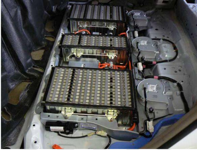
Şekil 2.4 : Toyota Highlander aracında kullanılan Ni-MH batarya [20].
