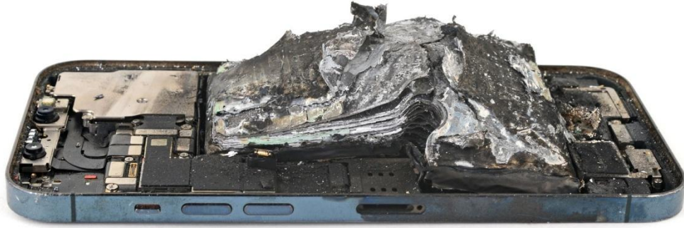
Şekil 2.5 : Isıl sürüklenme gerçekleşmiş bir cep telefonu bataryası [23].
