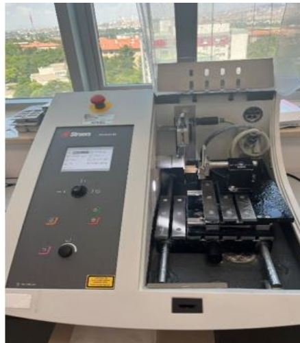
Şekil 17. Çalışmada kullanılan hassas kesim cihazı.
