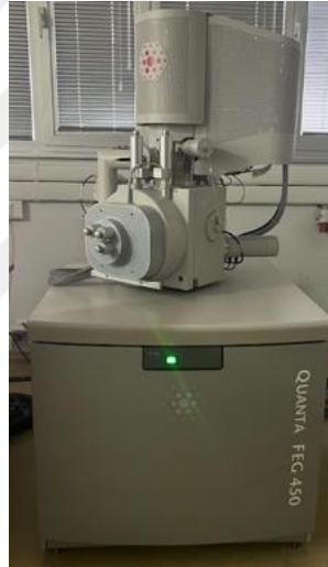
Şekil 35. SEM analizinde kullanılan cihaz.
