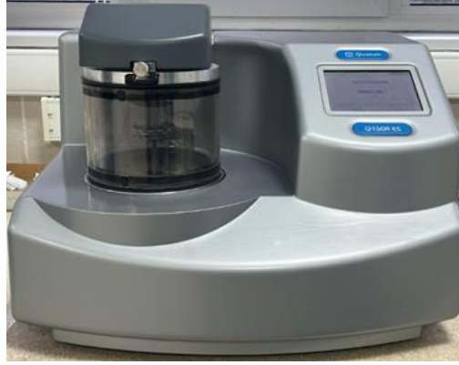
Şekil 34. Örneklerin kaplanmasında kullanılan cihaz.
