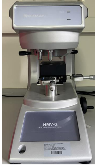
Şekil 32. Çalışmada kullanılan sertlik cihazı.
