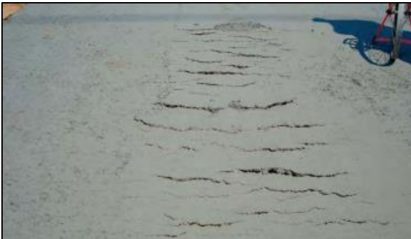
Resim 3.8. Sıkıştırma kaynaklı yırtılma (Harrington ve diğerleri, 2010)
