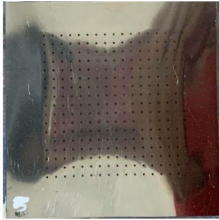
Şekil 3. 5. İki delik arası mesafe: 2500 \mu\text{m}
