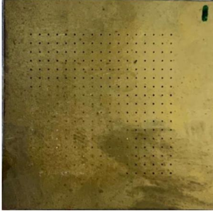
Şekil 3. 1. İki delik arası mesafe: 2500 µm
