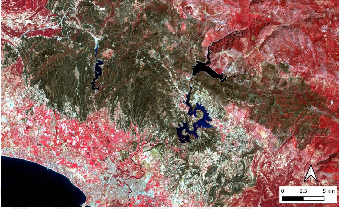
Şekil 3.6 : Topografik düzeltme uygulanmamış görüntü.
