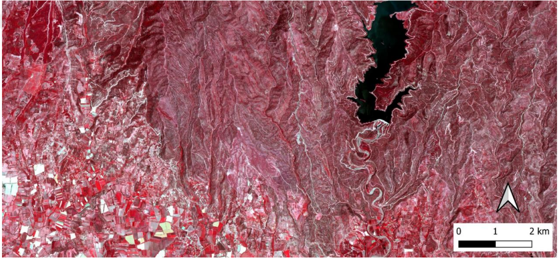
Şekil 3.16 : Topografik düzeltme uygulanmamış görüntü.
