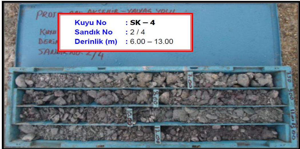
Şekil 4.21. SK-4 no'lu sondaj kuyusuna ait karot sandık fotoğrafından görünüm
