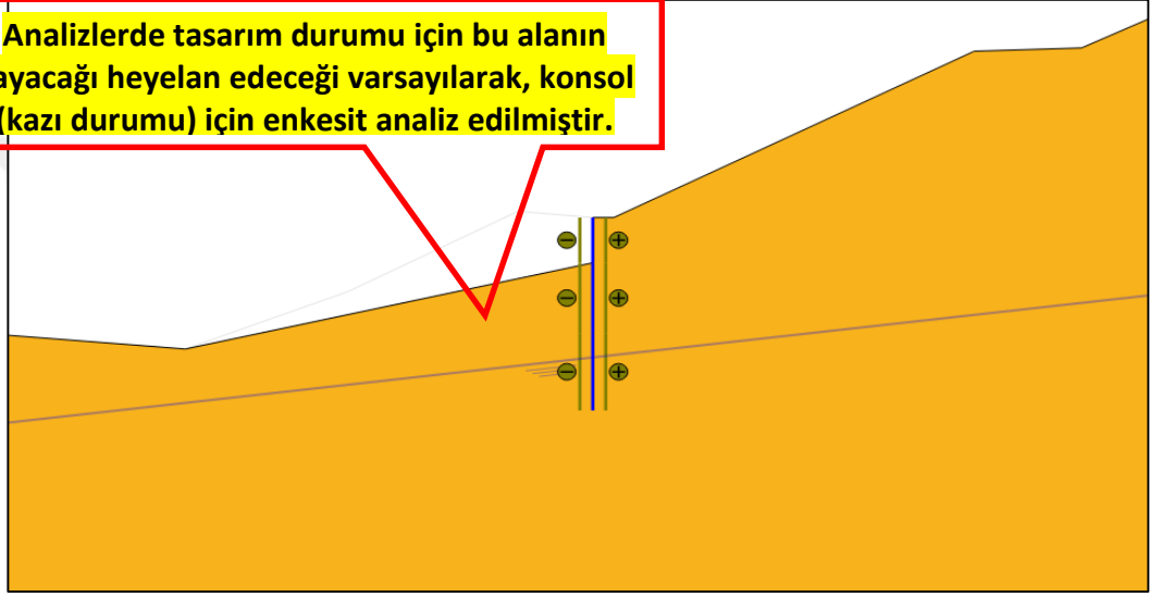
Şekil 4.32. Kazıklı tasarım için modelin kurulması (Plaxis 2D)
