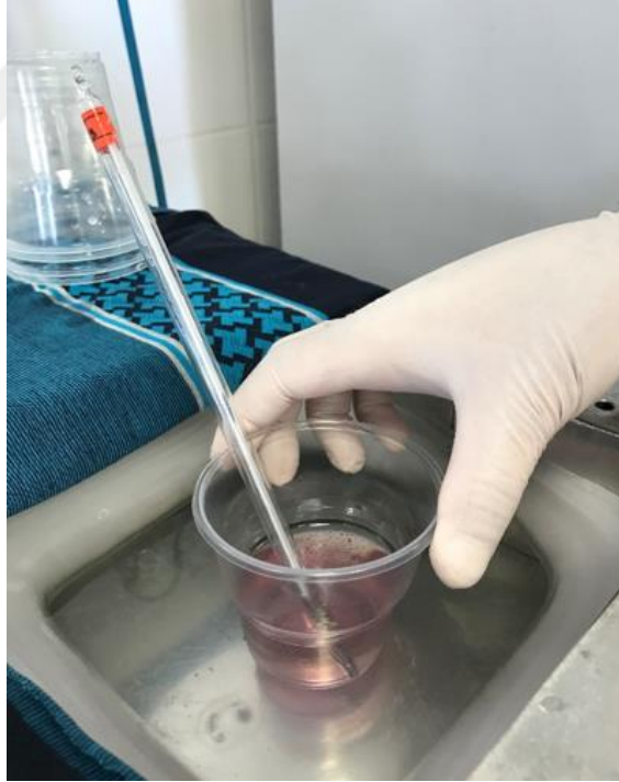
Şekil 5.3 22°C'ye soğutulan polyester numunesi
