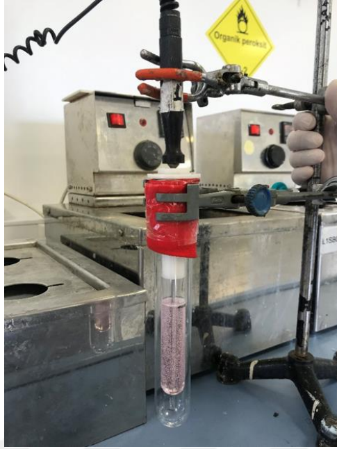
Őekil 5.6 UPR numunesinin test dzeneęi
