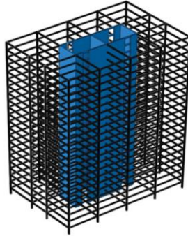
Şekil 4.27 : Betonarme perdeli çelik çerçeve sistem (URL-4).
