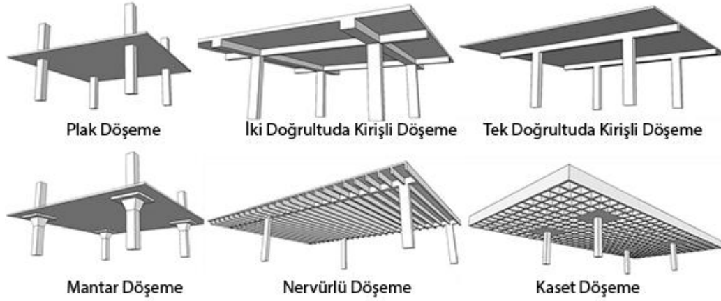
Şekil 4.8 : Betonarme döşeme tipleri (Özcan ve Diğerleri, 2019).
