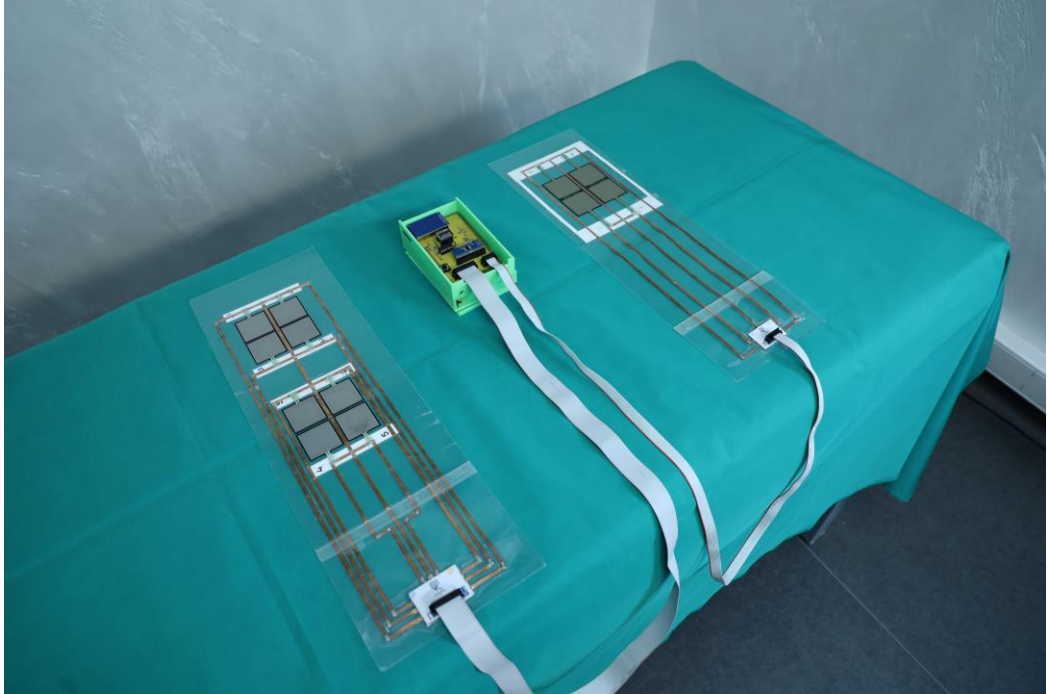
Şekil 11. Üç boyutlu spacer kumaş destek yüzey ve basınç ölçüm sisteminin görseli.
