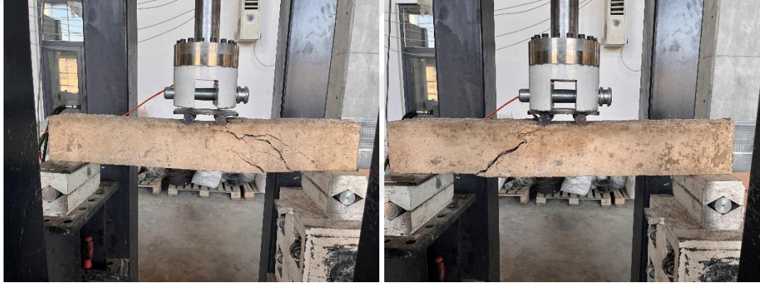
Şekil 4.127. C 20T-10 ve C 20T-16 numunelerin deney sonu görüntüleri
