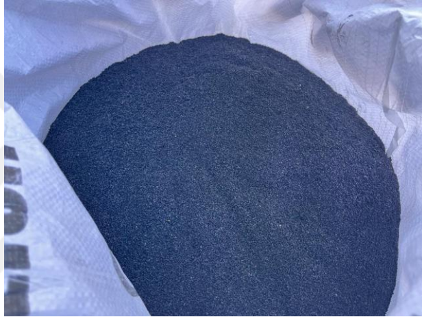
Şekil 4.4. Atık lastiklerden toz olarak isimlendirilen kauçuk türü
