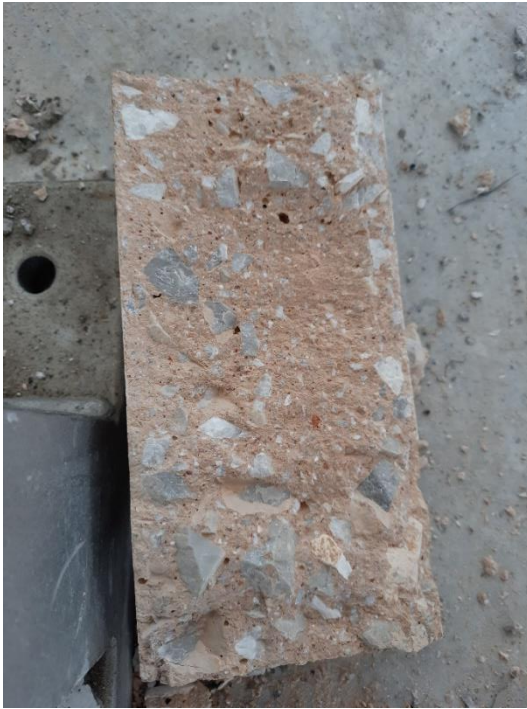
Şekil 4.22. Referans (katkısız) numune
