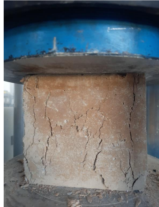
Şekil 4.13. %2 atık tel içeren numunenin son hali
