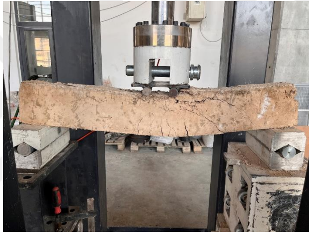
Şekil 4.48. B 5K-10 isimli numunede gözlemlenen hem kesme hem eğilme çatlakları
