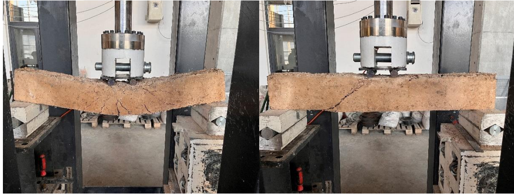
Şekil 4.92. B 5M-10 ve B 5M-16 numunelerin deney sonu görüntüleri
