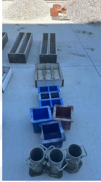
Şekil 4.6. 1 set farklı numuneler için hazırlanmış kalıplar
