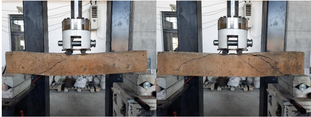
Şekil 4.80. A 10T-10 ve A 10T-16 numunelerin deney sonu görüntüleri
