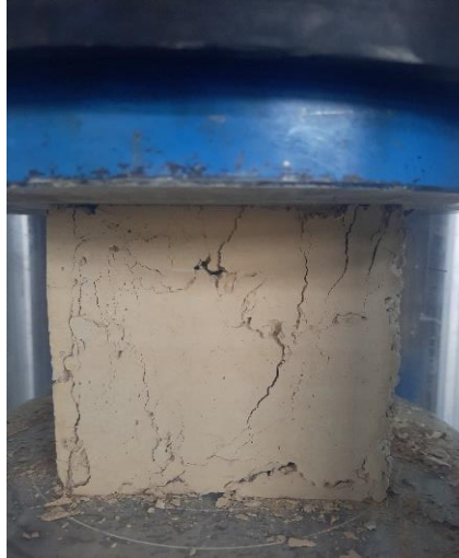
Şekil 3.8. Çalışmada uygulanan basınç deneyi
