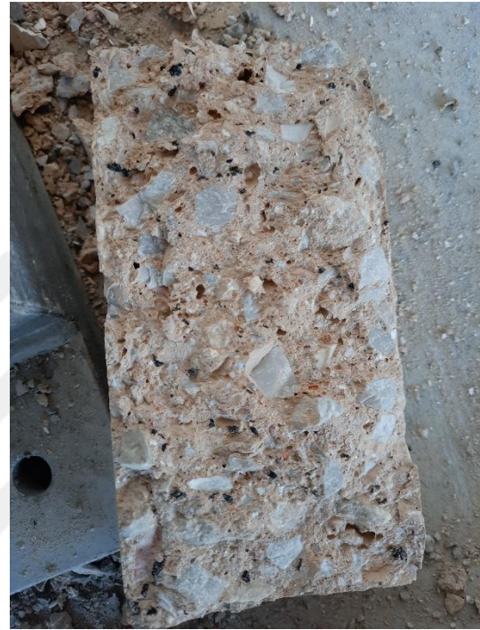
Şekil 4.23. Mercimek türü atık lastik katkıli numune
