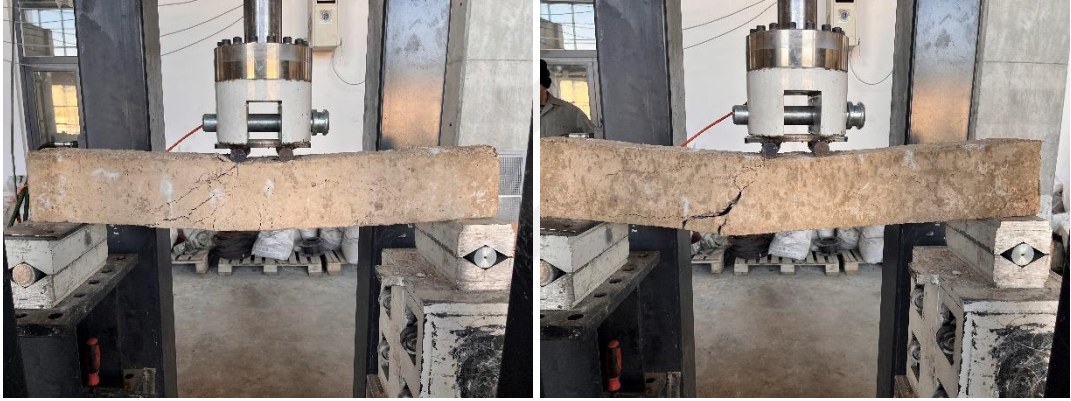
Şekil 4.121. C 10T-10 ve C 10T-16 numunelerin deney sonu görüntüleri
