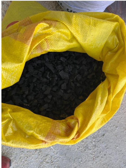
Şekil 4.5. Atık lastiklerden kuşbaşı olarak isimlendirilen kauçuk türü
