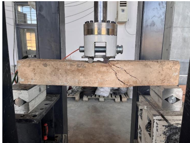
Şekil 4.46. C 10K-16 isimli numune gözlemlenen kesme çatlakları
