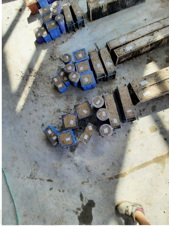
Şekil 4.10. Kalıplara dökülmüş numune örnekleri
