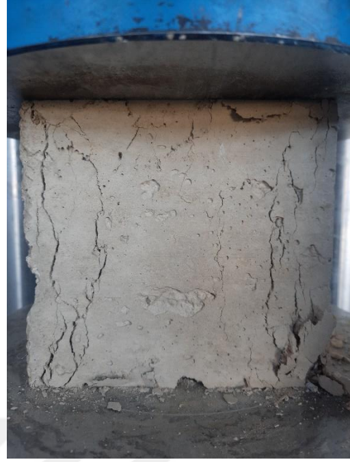
Şekil 4.15. %2 atık tel ve %20 kuşbaşı içeren numune
