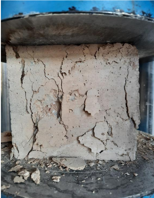
Şekil 4.12. Referans numunenin deney sonucu son hali
