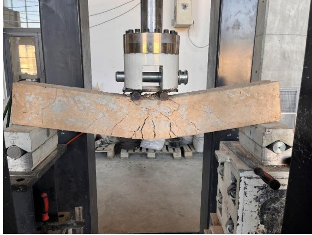
Şekil 4.47. Ref 10K-10 isimli numunede gözlemlenen eğilme çatlakları
