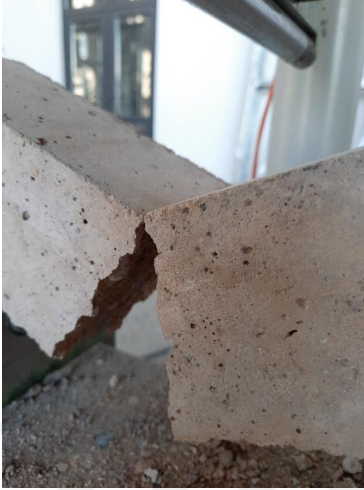
Şekil 4.32. Katkısız küçük kiriş numune
