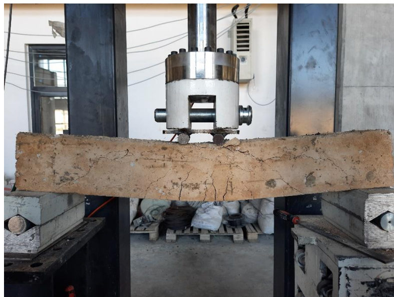
Şekil 3.13. Çalışmada uygulanan eğilme deneyi
