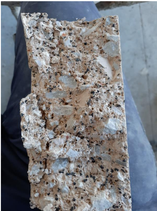
Şekil 4.24. Toz türü atık lastik katkıli numune
