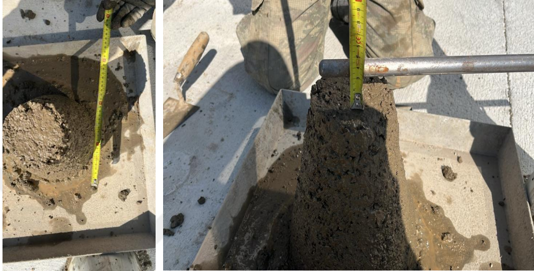
Şekil 4.8. Döküm öncesi slump deneyleri
