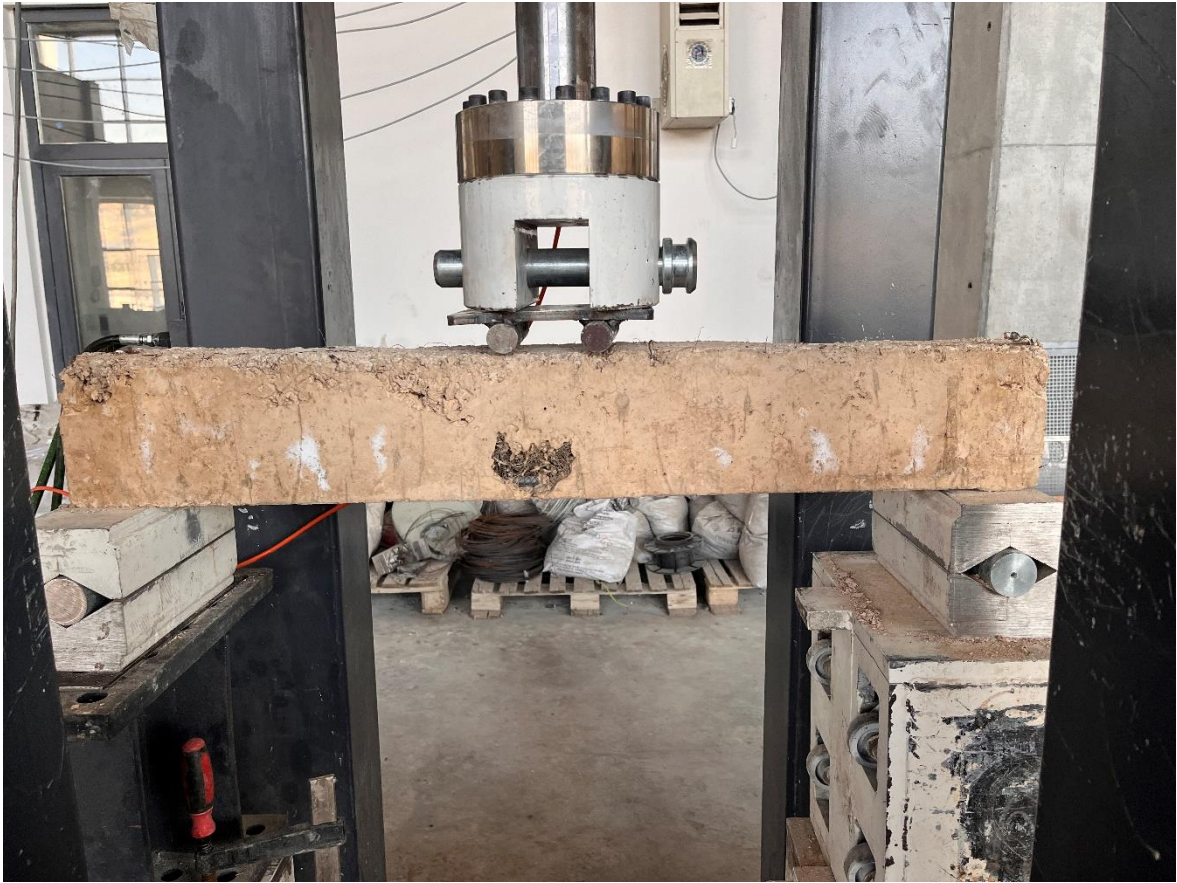
Şekil 4.109. B 5K-16 numunesi
