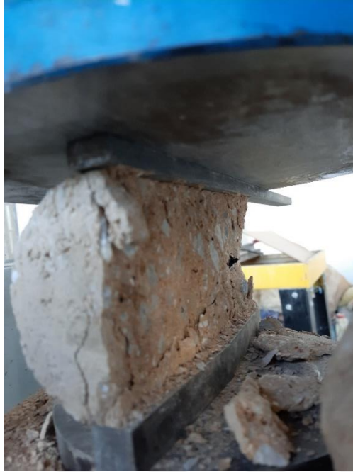
Şekil 3.15. Çalışmada uygulanan silindir deneyi
