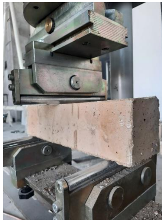
Şekil 3.18. Çalışmada uygulanan çekme deneyi
