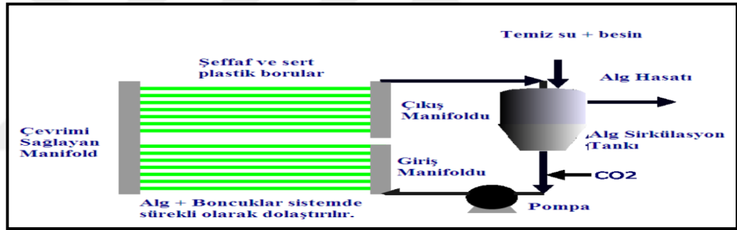
Şekil 2.12. Tübüler fotobiyoreaktörlerin çalışma şekli (Gezici, 2012).
