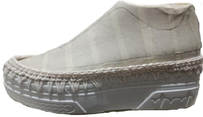
Resim 36. Naplar koleksiyonu tabanlık örme ve kalıp hazırlanışı
