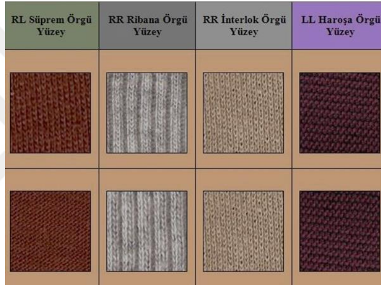
Resim 22. Temel örme yapılarının yüzey görünümleri
