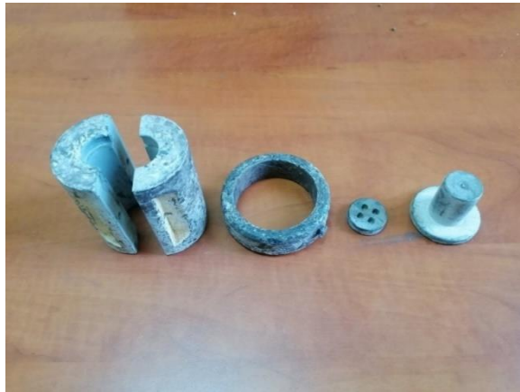
Şekil 4.5: Kalıp gövdesi, kelepçe, alt pul ve piston.
