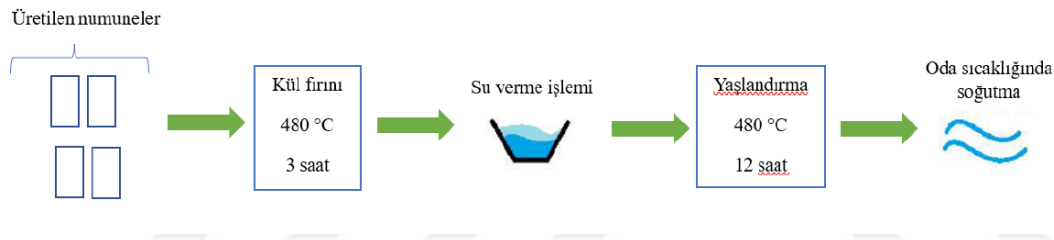
Şekil 5.7: T6 ısıl işlem uygulama adımları.
