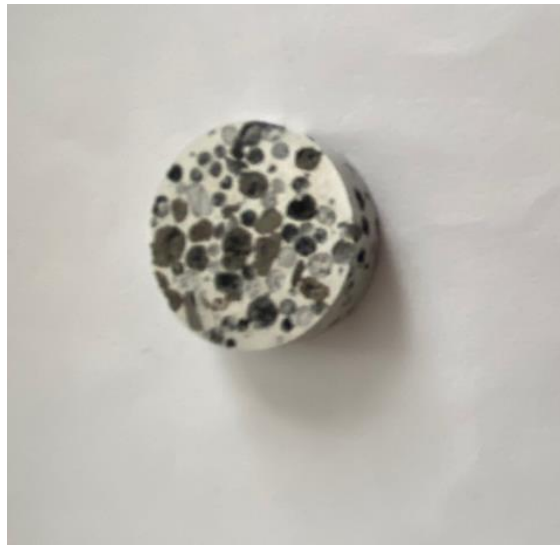
Şekil 5.2: Makro boyutsal incelenen hibrit takviyeli numune.
