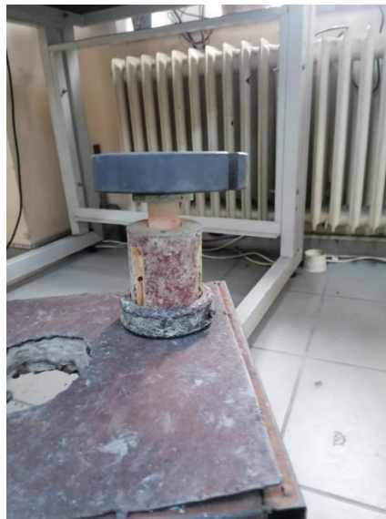
Şekil 4.12: Kalıptan çıkarılan ve kuvvet uygulanmış kalıp.
