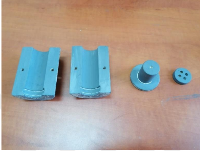
Şekil 4.6: Yağlanmış kalıp elemanları.
