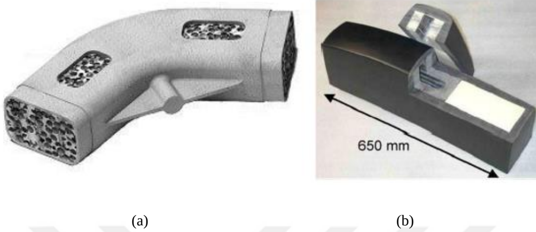
Şekil 2.13: Metal köpüklerin (a) otomotiv ve (b) raylı sistemlerde darbe emici uygulamaları. [45]
