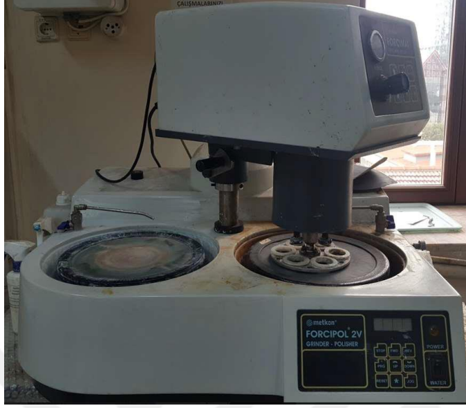
Şekil 5.1: METKON FORCIPOL® zımparalama ve taşlama makinesi.
