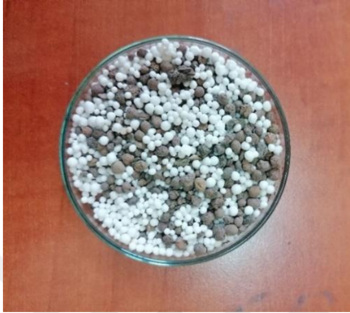
Şekil 4.3: Hibrit takviye malzeme.
