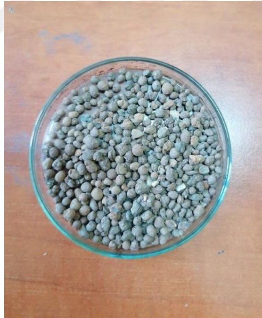
Şekil 4.2: Genişletilmiş kil malzeme.
