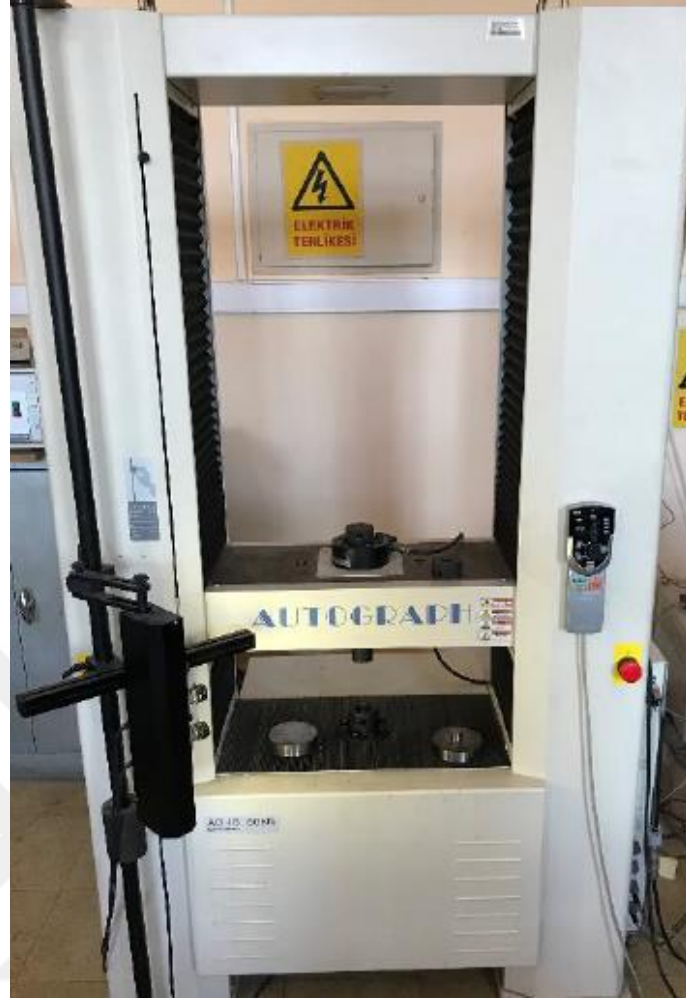
Şekil 5.8: Schimadzu AG-IS 50 kN cihazı.
