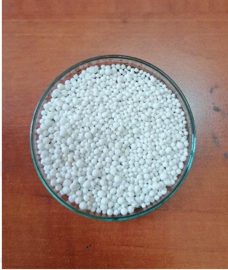
Şekil 4.1: Genleştirilmiş cam malzeme.
