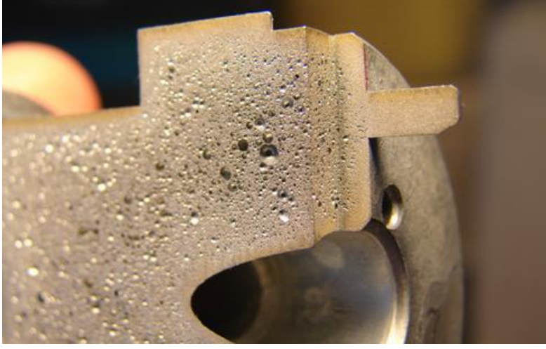
Şekil 2.15: Metal köpük kullanılarak üretilme makine elemanı kesiti. [45]
