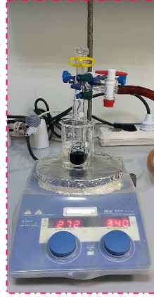
Şekil 102. \text{HY}_3\text{-ZnPc}^{\text{D/np}} 'nin sentezine ait reaksiyon düzeneği
