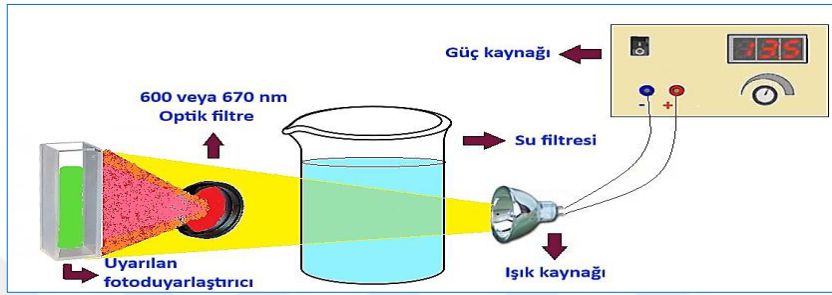
Şekil 83. Fotokimyasal ölçüm düzeneği
