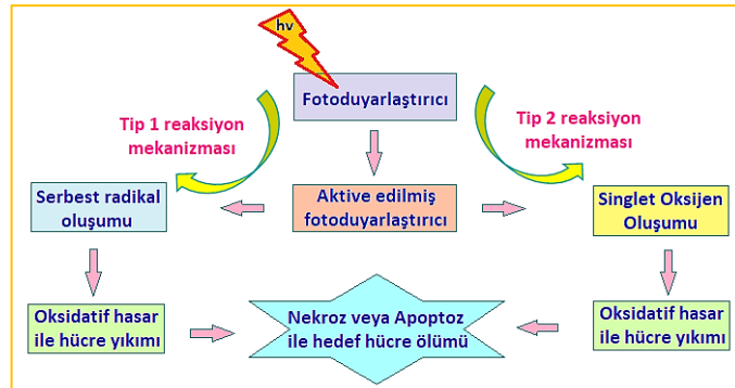
Şekil 77. PDT’de ROS oluşum mekanizmaları olan Tip 1 ve Tip 2 reaksiyonlarının şematik gösterimi
