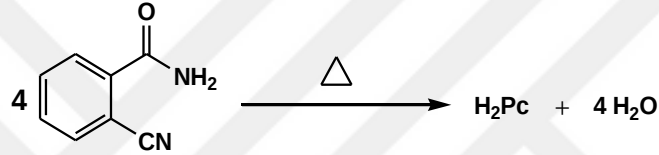
Şekil 1. Metalsiz ftalosiyaninin o-siyanobenzamid sentezi sırasında elde edilme reaksiyonu
