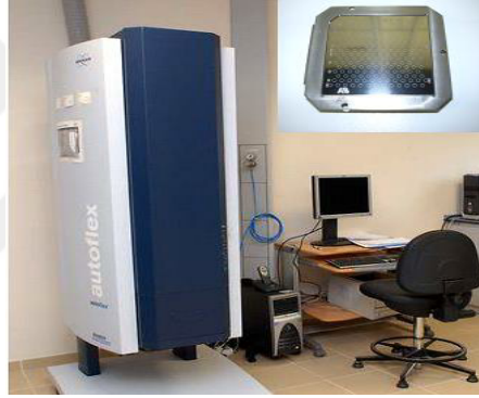
Şekil 45. MALDI-TOF cihazı ve numune verilen hedef aparat (sağ üst)
