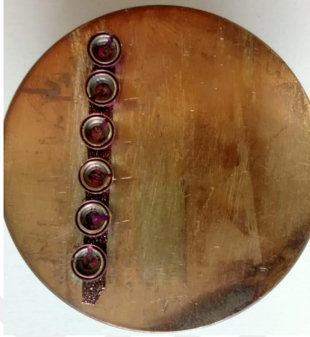
Şekil 3.24 Plakaya sabitlenen sputter kaplama ile altın kaplanmış lastik örnekler
