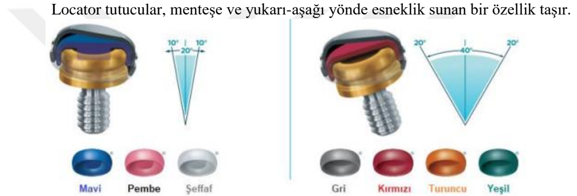
Şekil 2.9 Düz ve açılı Locator tutucu sistemde dayanak ve naylon tutucuların tutuculuk kuvvet değerlerine göre renk kodları (Locator, 2023).
