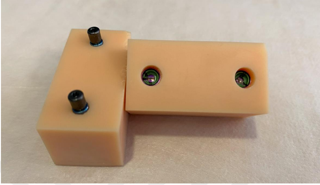
Şekil 3.19 Tutuculuk testlerine hazır örnekler
