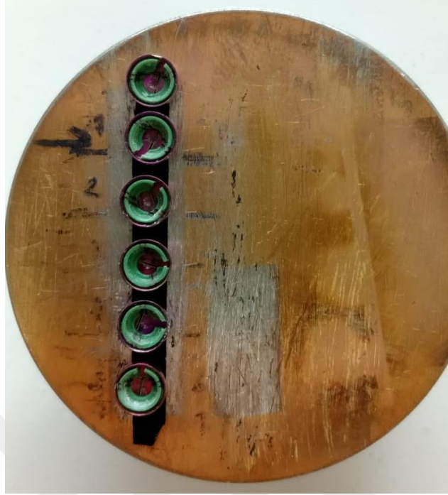
Şekil 3.22 Plakaya sabitlenen metal kep ve kaplamasız yeşil lastik örnekler
