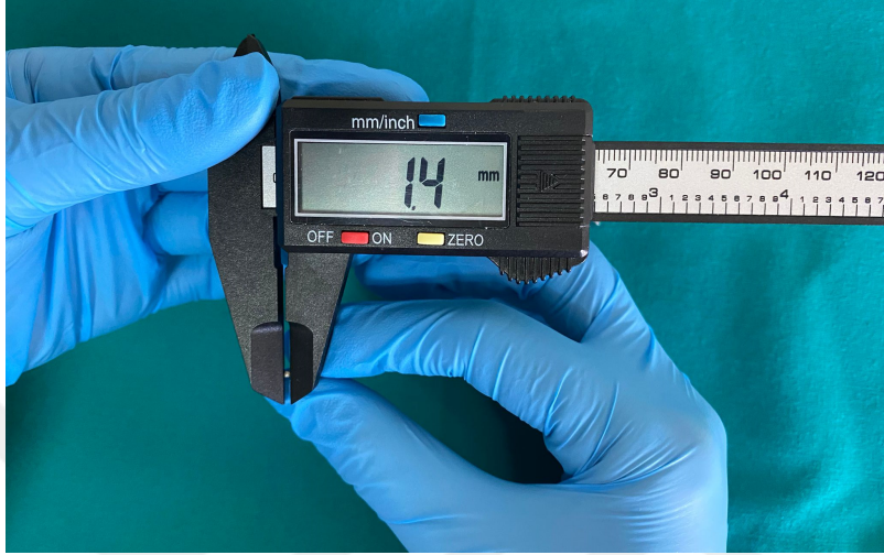
Şekil 3.4: Perforasyonun oluşturulacağı rond frez çapının kumpas ile ölçülmesi
