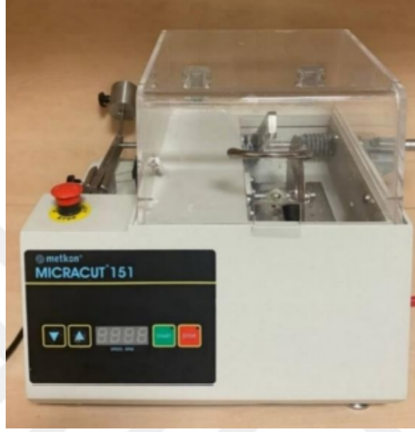
Şekil 3.10. Örneklerin kesitlere ayrıldığı microcut cihazı
