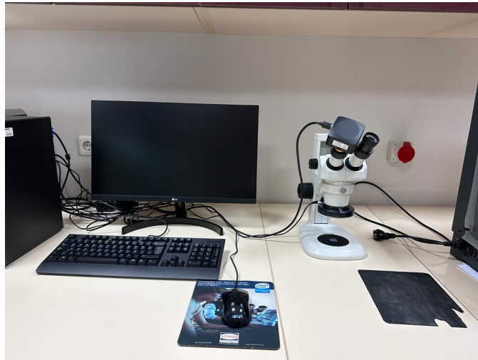
Şekil 3.11: Örneklerin incelendiği stereomikroskop cihazı.
