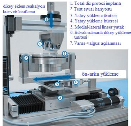
Şekil 15: Endolab firmasının ürettiği ve testlerini yaptığı ASTM F1223 ve ASTM F2724 standartlarında çalışabilen test cihazı [39] .
