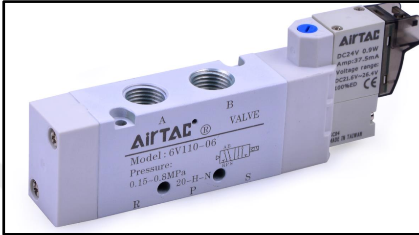
Şekil 43. Airtac 6V110-06 24V tek bobinli 5 yol 2konumlu solenoid valf.
