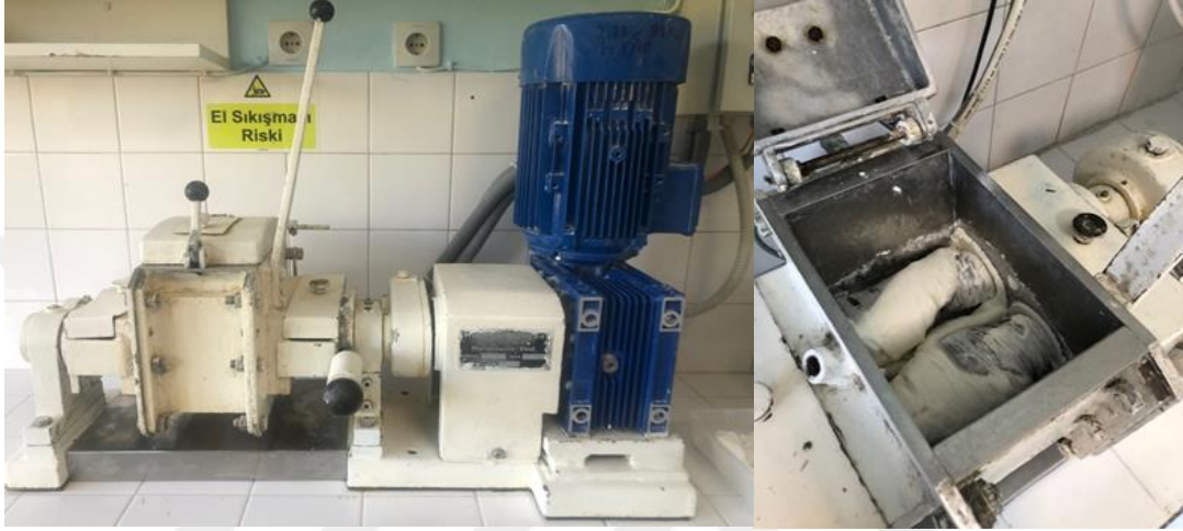
Şekil 2.2: Laboratuvar tipi sakız mikseri ( Kaynak: Yazar tarafından oluşturulmuştur.)
