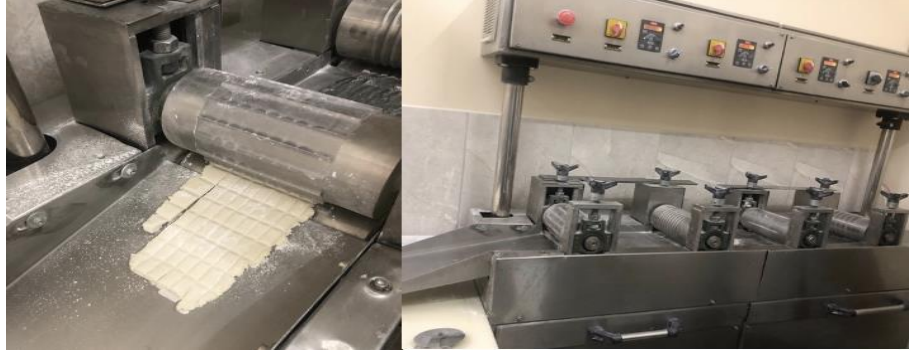
Şekil 2.3: Sakız şekil verme ve kesme ünitesi ( Kaynak: Yazar tarafından oluşturulmuştur.)
