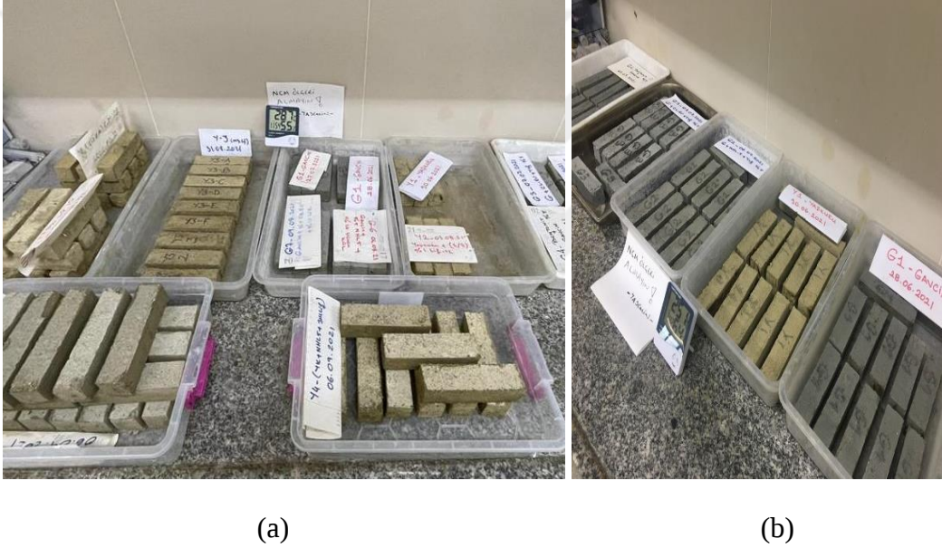
Şekil 5.28 a,b) Kürde bekleyen numuneler (YTÜ Yapı Malzemeleri Laboratuvarı, 2021)
