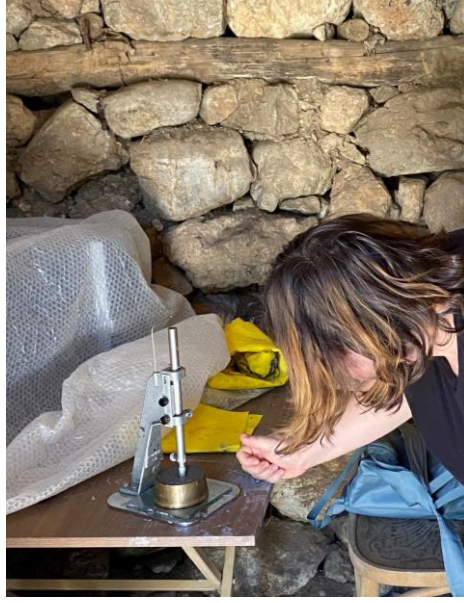
Şekil 5.35 Su muhtevelarının belirlenmesi için alanda vicat kıvam deneyi yapılması (Erzincan, Kemaliye – Alan çalışması, 2022)
