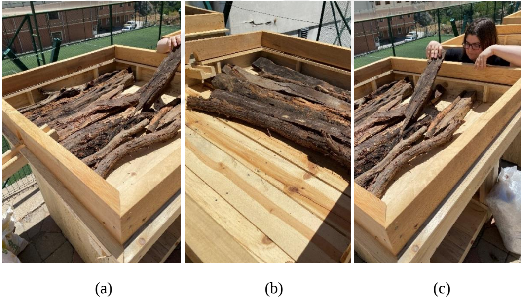
Şekil 6.14 a,b,c) Dam modellerinin ahşap konstrüksiyonu ve merteklerin yerleştirilmesi
