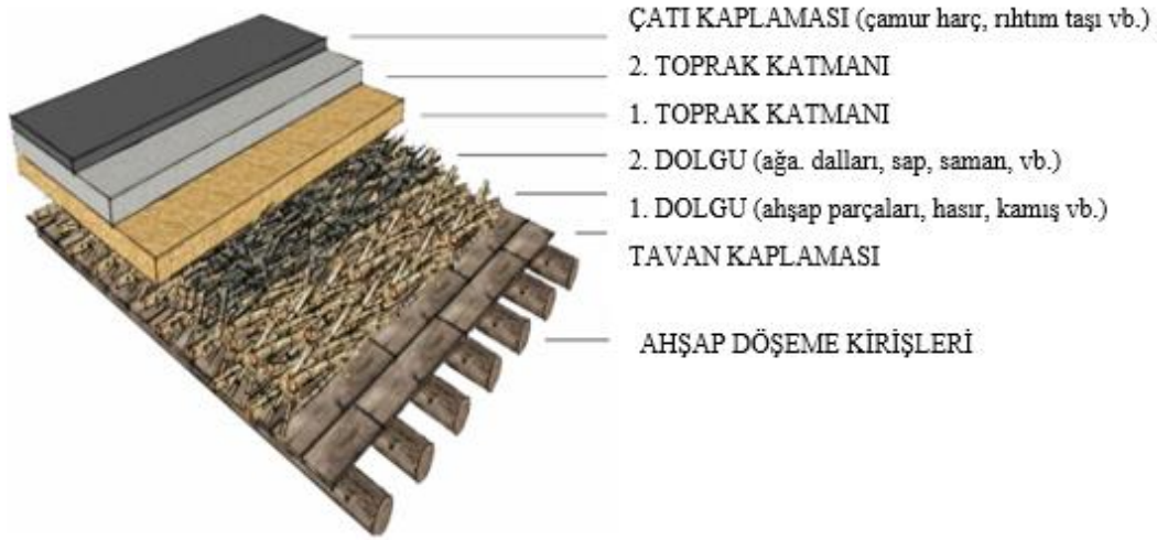
Şekil 2.13 Anadolu'daki Düz Toprak Dam Katmanları [56]
