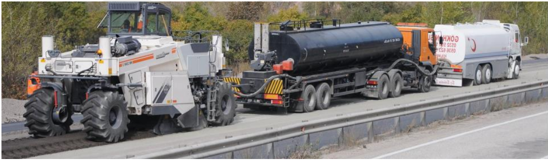
Şekil 17. Yerinde soğuk geri dönüşüm uygulaması (Orhan 2012)
