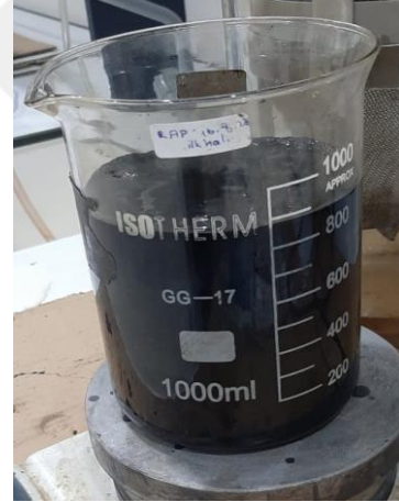
Şekil 21. Atık asfalt betonu malzemesi ve geri kazanılmış bitüm
