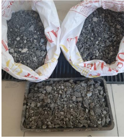
Şekil 21. Atık asfalt betonu malzemesi ve geri kazanılmış bitüm
