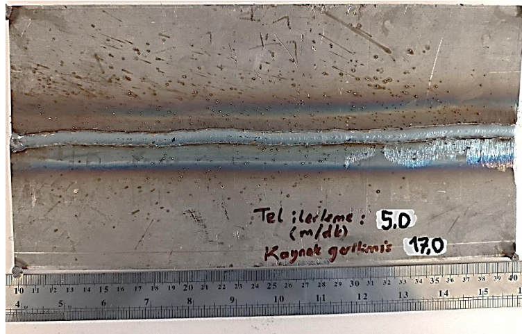
Şekil 4.6. Kaynaklanmış bir plakaya ait cetveli yan görüntü (300 mm)
