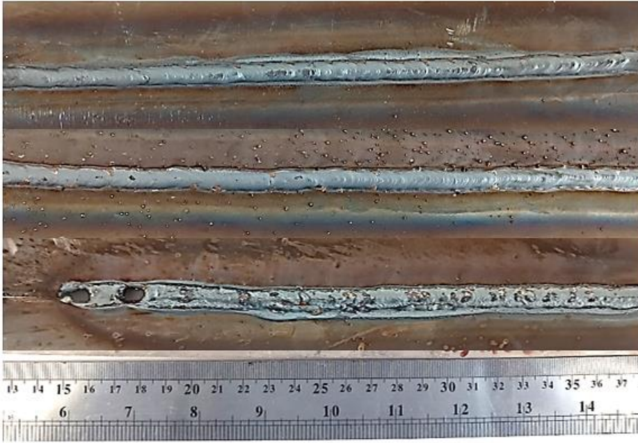
Şekil 5.2. 2A, 2B ve 2C plakalarına ait kaynak dikiş görüntüleri (sırasıyla)
