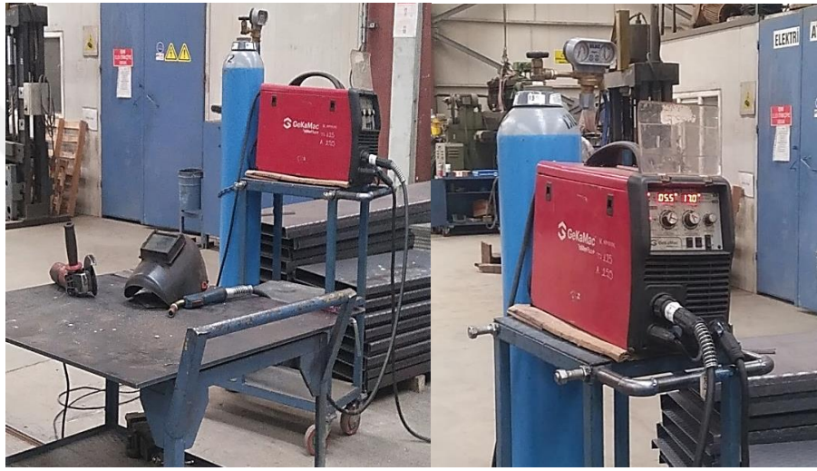
Şekil 4.2. Kaynak işleminde kullanılan kaynak makinesi ve donanımları
