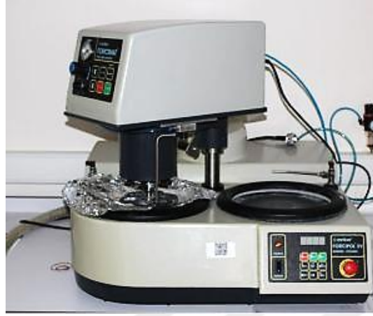
Şekil 4.15. Metkon Forcipol 2V marka zımparalama-parlatma cihazı
