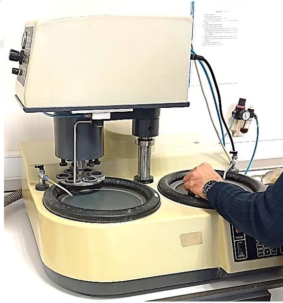
Şekil 4.16. 2B numunesi zımparalama işlemi görüntüsü
