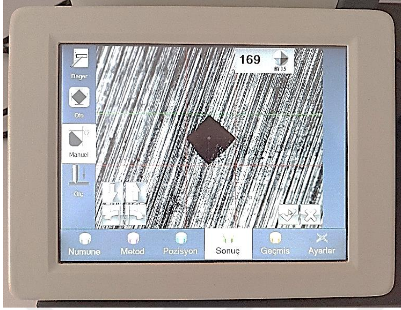
Şekil 4.20. Mikroyapı numunesi dışındaki bir numuneye ait iz görüntüsü ve HV 0,5 yük altındaki sertlik değeri
