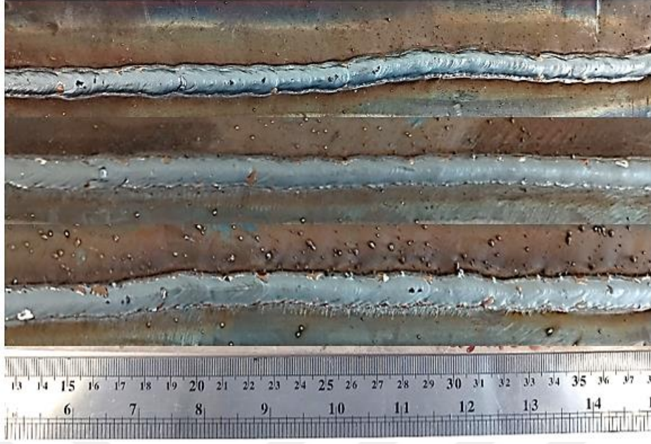
Şekil 5.3. 3A, 3B ve 3C plakalarına ait kaynak dikiş görüntüleri (sırasıyla)
