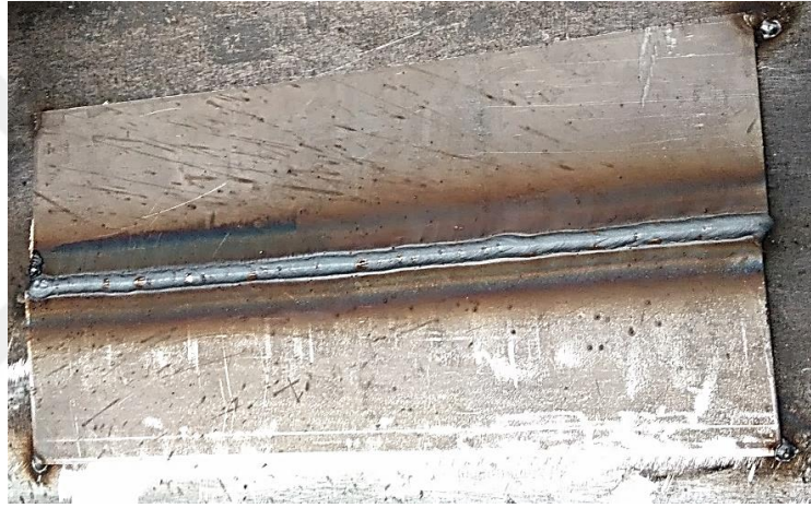
Şekil 4.5. Kaynaklanmış plaka görüntüsü ve kaynak dikişi
