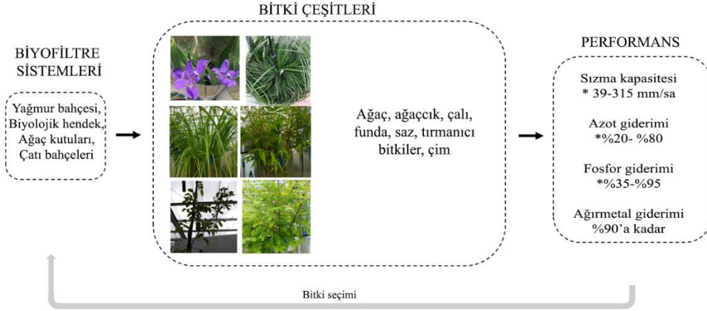
Şekil 2.10 Yağış suyu tesislerinde bitkilerin su tutma işlevleri üzerine yapılan performans testi (Fowdar et al., 2022).
