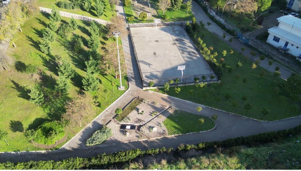
Şekil 2.17 Buca taşkın parkı, biyolojik hendek, kesik bordür ve taşkın drenaj kuyuları uygulaması (İBB-Su Kaynakları Araştırma ve Uygulama Merkezi, 2023).
