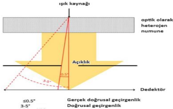
Şekil 2.5 : Doğrusal geçirgenlik ile gerçek doğrusal geçirgenlik ölçümleri arasındaki farkın gösterimi [61].
