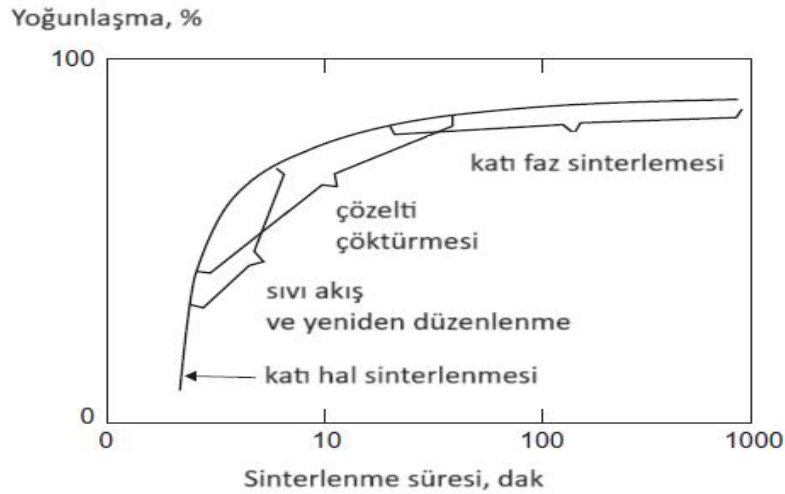
Şekil 4.8 : Sıvı faz sinterlemesinde örtüşen yoğunlaşma adımları [88].
