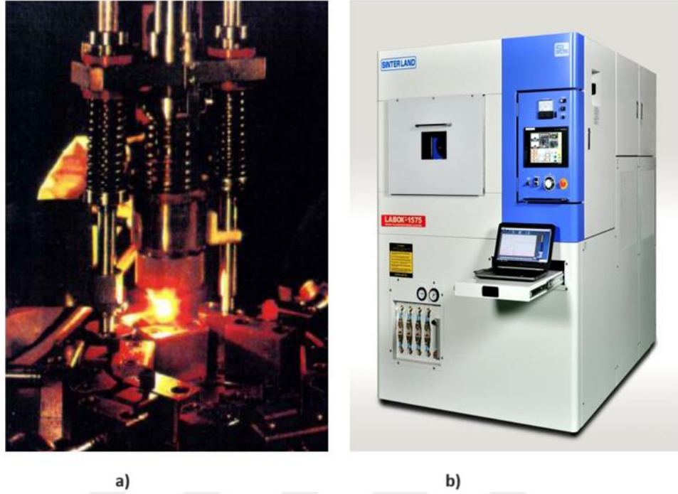
Şekil 4.16 : a) 1. nesil SPS cihazı örneği (açık hava sistemi), b) 5. Nesil SPS cihazı örneği (vakum sistemi) [94].
