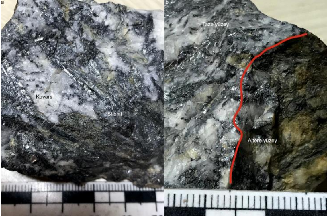
Fotoėraf 4.11. Ksmen masif yapıda stibnit cevheri makro yakın plan grnmleri. (St beyaz (a) renkteki kuvars ierisinde iğnemsî stibnit kristalleri (b) net olarak ayırt edilebilmektedir.)
