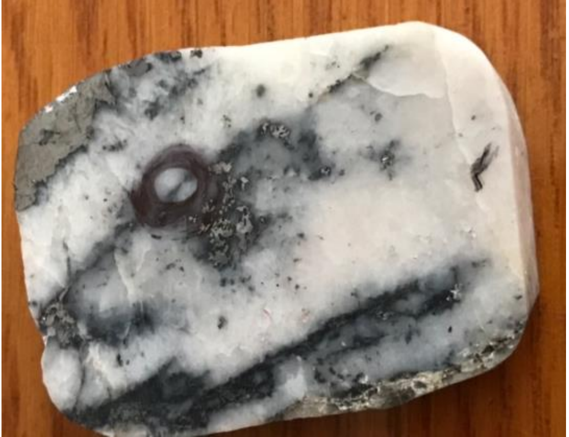
Fotoğraf 4.14. Mineral kimyası analizleri yapılan örnek kuvars kayacı içerisindeki stibnit, sfalerit ve pirit cevher minerali.
