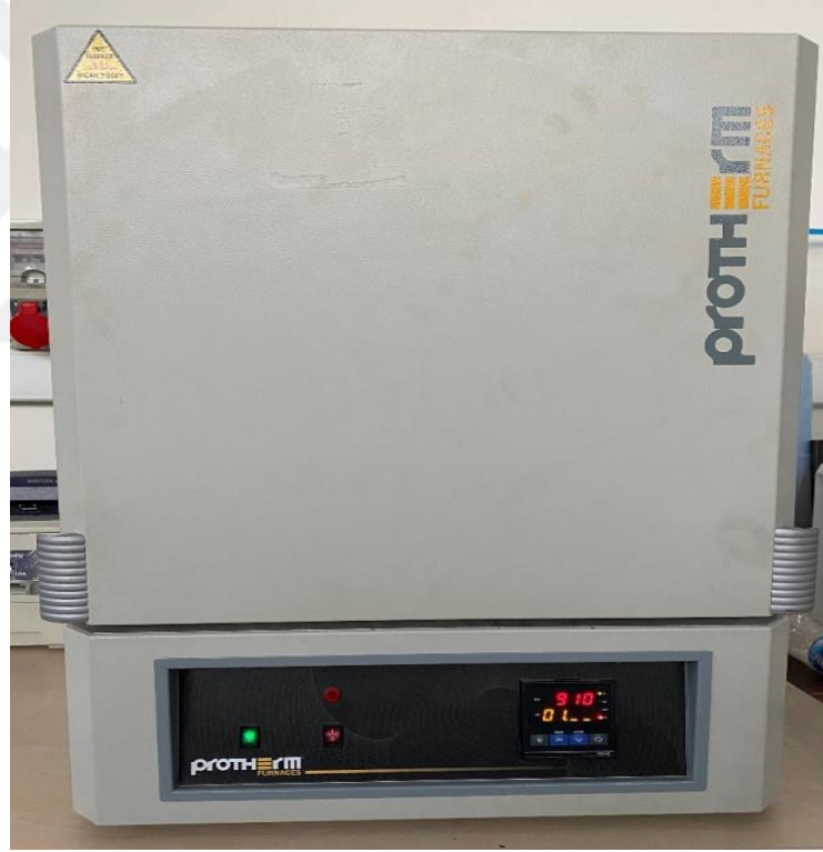
Fotoğraf 7.6. Protherm Marka Sinterleme Fırını (Kül Fırını) (Max. Sıcaklık 1200°C)
