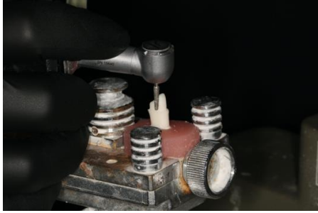
Şekil 1. Maksiller rezin dişin paralelometre yardımıyla preparasyonu
