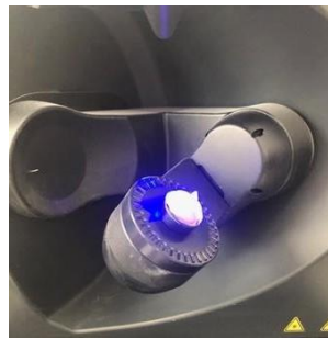
Şekil 3a. Epoksi rezin dayanağın taranması
