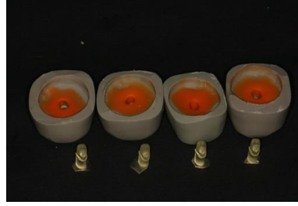
Şekil 2. Silikon indeks yöntemiyle üretilen epoksi rezin dayanaklar
