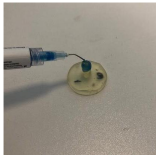
Şekil 6. Epoksi rezin dayanağa asit uygulanması
