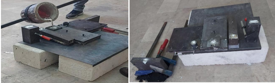
Şekil 17: Döküm İşlemi ve Döküm Sonrası Kalıp Görüntüleri
