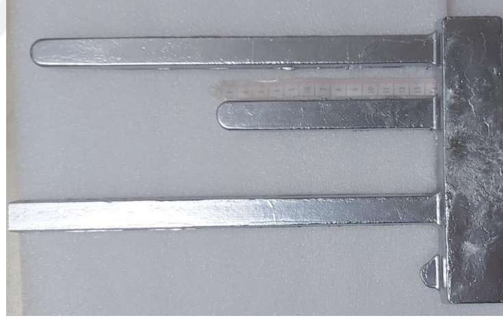
Şekil 23: Sıvı Metal İlerleme Mesafelerinin Ölçülmesi
