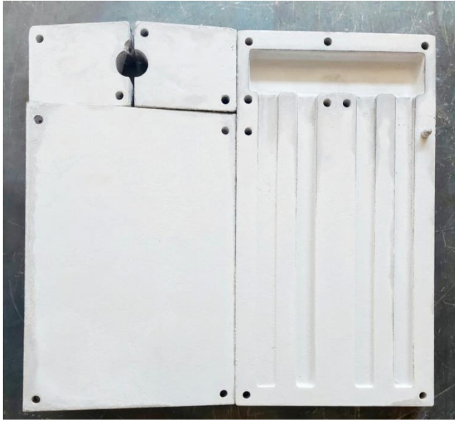
Şekil 22: 4 Kanallı Akıcılık Kalıbı ve Numune Ölçüleri
