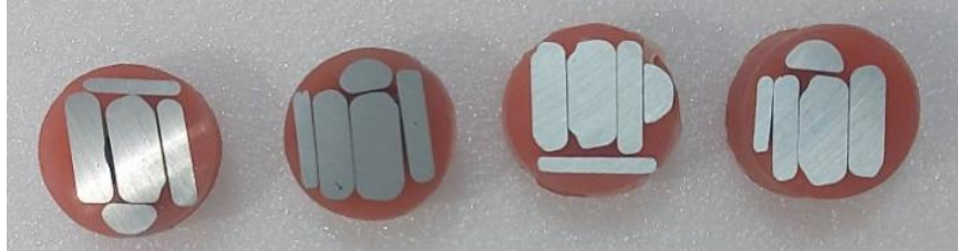
Şekil 31: Mikroyapı Numunelerini Bakalite Alınması ve Numune Örnekleri
