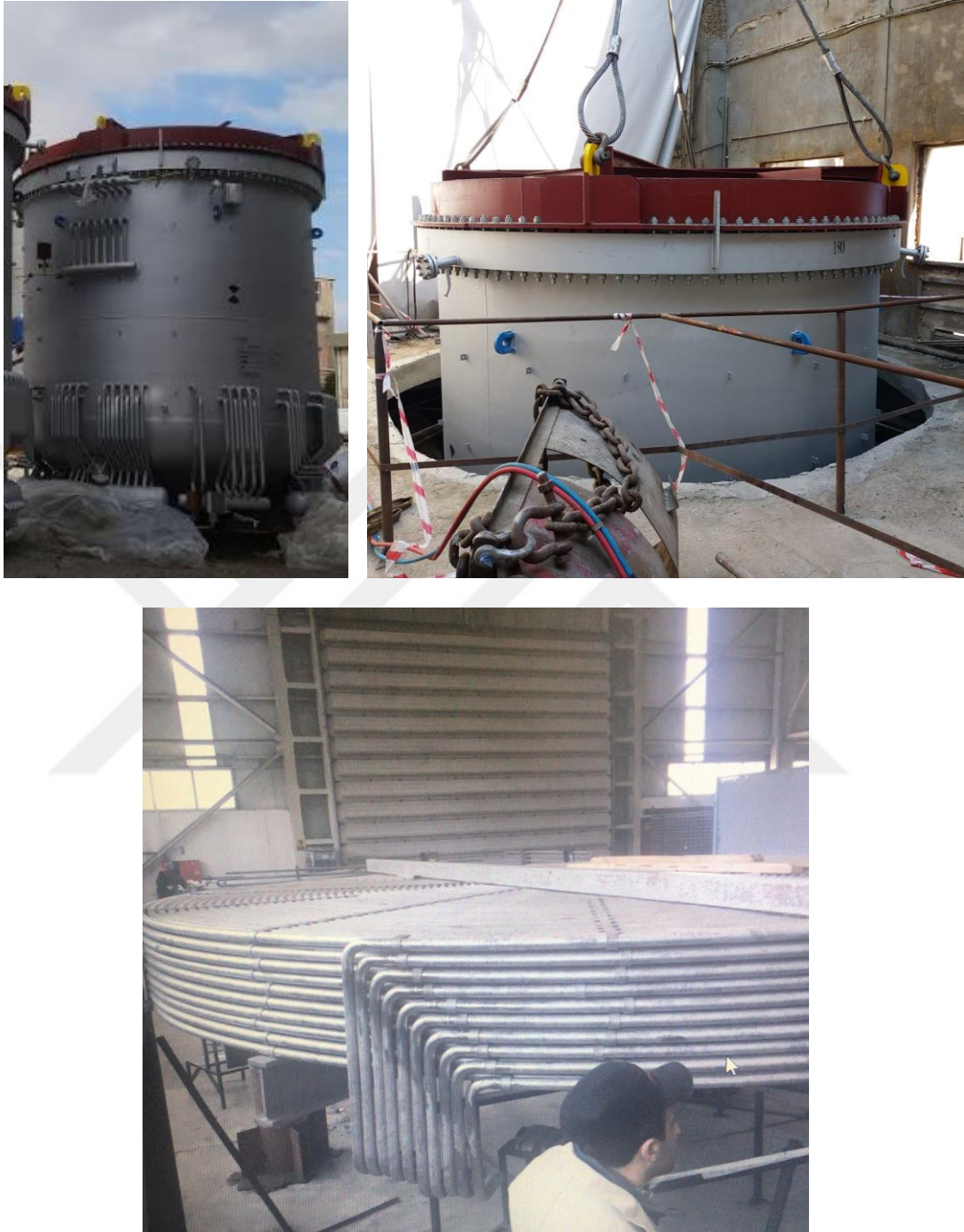
Şekil 4.2. Yeni reaktör ve spiral şeklinde sarımlı serpantinler.
