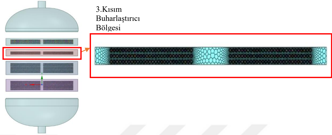
Şekil 4.21. Sayısal model buharlaştırıcı bölgesi mesh gösterimi.
