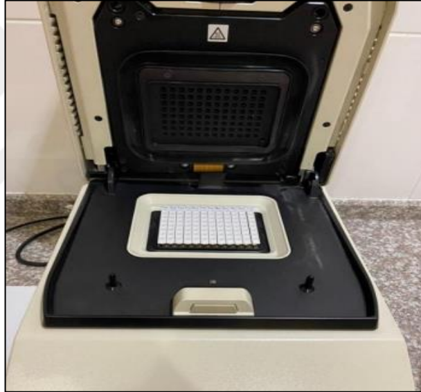
Resim 3.12. Biorad CFX96 (California/USA) Gerçek Zamanlı PCR Cihazında Gen Ekspresyon
