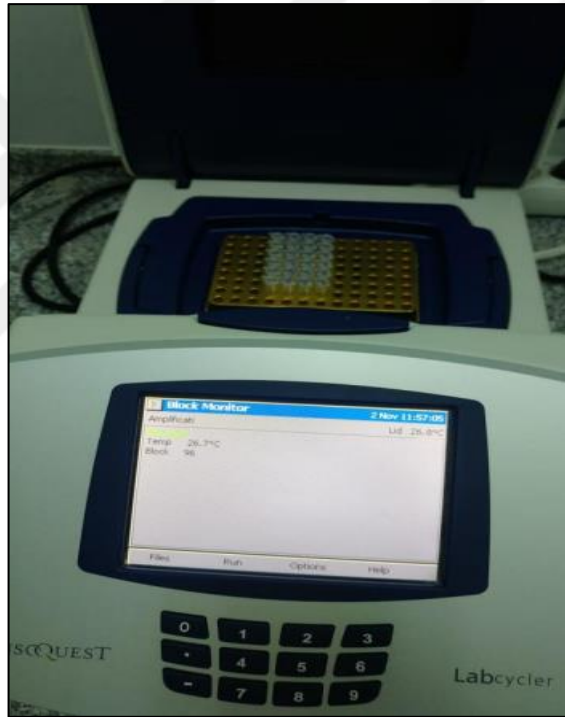
Resim 3.10. Termal Döngü Cihazına Hazırlanan Karışım Örneklerinin Yüklenmesi
