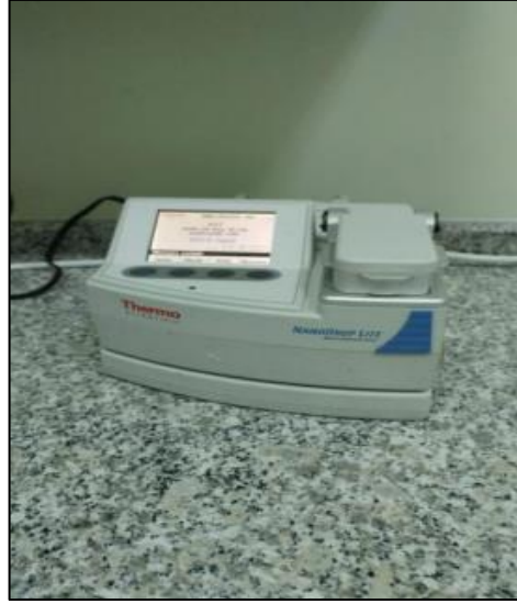
Resim 3.7. RNA Örneklerinin Nanodrop Cihazında Saflık ve Miktar Tayininin Yapılması
