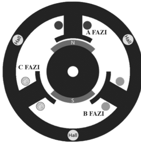
Şekil 3.36. Hall sensörlerinin stator üzerine yerleştirilmesi
