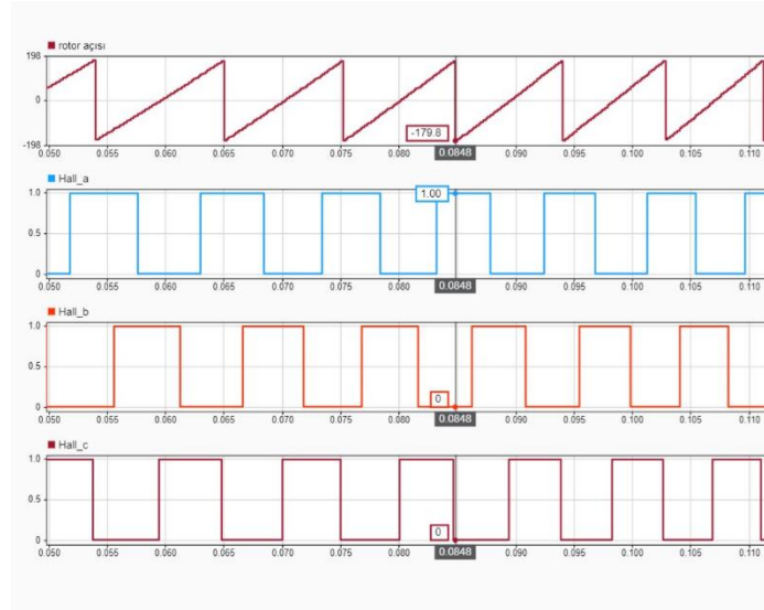
Şekil 4.7. Rotor konumuna göre hall sensörlerinden alınan sinyal
