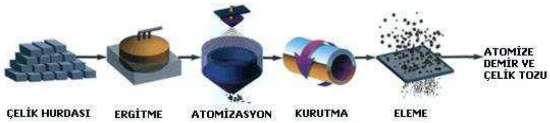
Şekil 4.4. Tozların atomizasyon yöntemiyle üretimi (Ayata, 2014)
