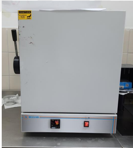
Şekil 5.5. Etüv fırınında kurutma işlemi
