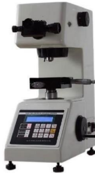
Şekil 5.14. Vickers sertlik ölçüm cihazı
