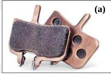
Şekil 4.11. Toz metalürjisi yöntemiyle üretilmiş fren balataları (a) ve dişliler (b) (Söyler, 2007)
