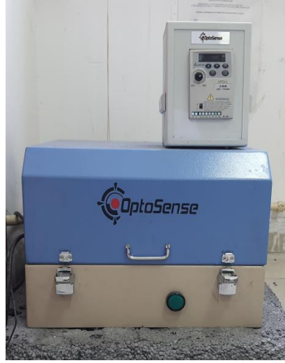
Şekil 5.3. Yüksek enerjili bilyalı değirmende karıştırma işlemi
