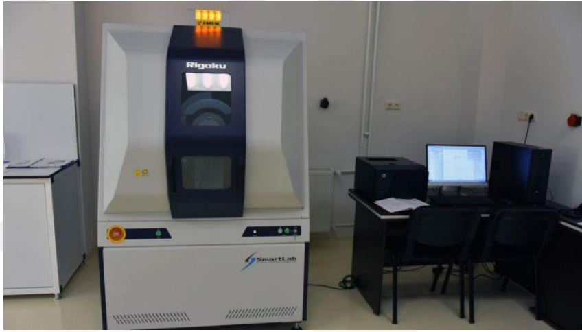
Şekil 5.21. X-ışını kırınımı (XRD) cihazı
