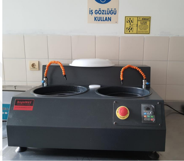
Şekil 5.13. Zımparalama ve parlatma makinesi
