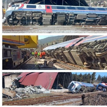
Fotoğraf 3.46 Deprem sarsıntısı nedeniyle devrilen vagonlar
