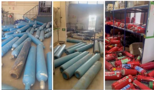
Fotoğraf 3.102 LPG depolama tesisinde devrilmiş gaz tüpleri
