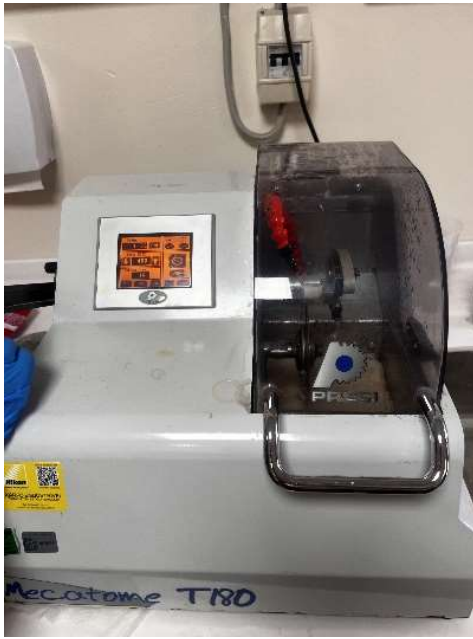
Şekil 3. 6: Mecatome T180 Hassas kesim cihazı
