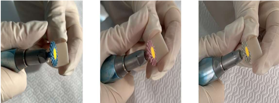
Şekil 3. 12: Sırasıyla mavi, pembe, gri polisaj lastik uygulaması
