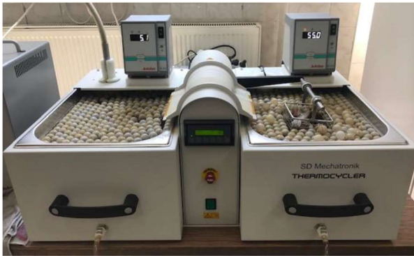
Şekil 3. 22: SD Mechatronic termal siklus cihazı
