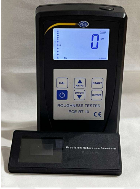
Şekil 3. 26: PCE-RT 10 yüzey pürüzlülük ölçüm cihazı ve kalibrasyon plağı
