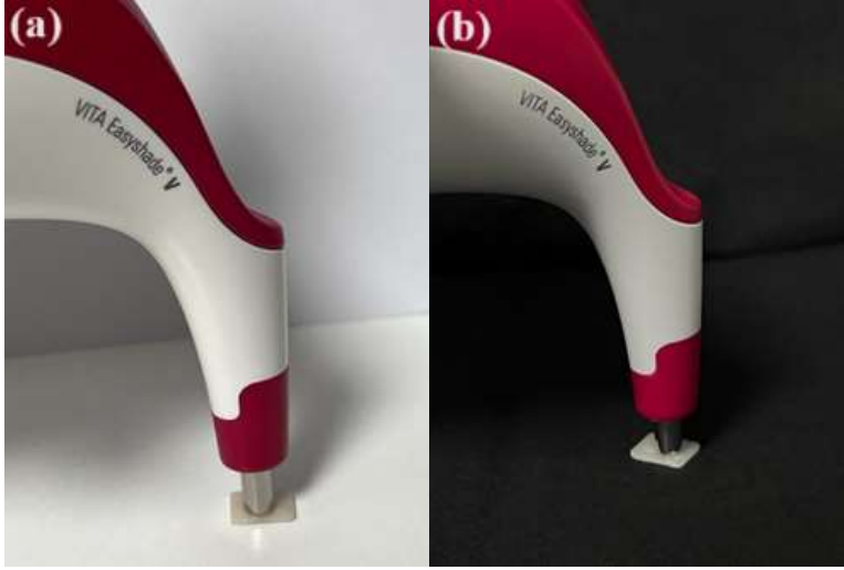
Şekil 3. 24: Örneklerin beyaz (a) ve siyah (b) zeminde renk ölçümlerinin yapılması
