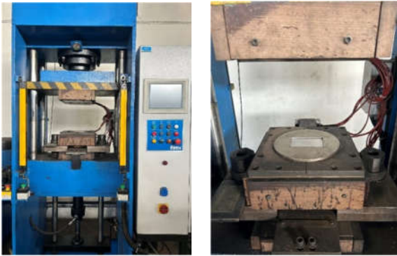
Şekil 5.6 Laboratuvar tipi hidrolik pres a)presin dış görünüşü b)numunelerin hazırlandığı kalıp görüntüsü
