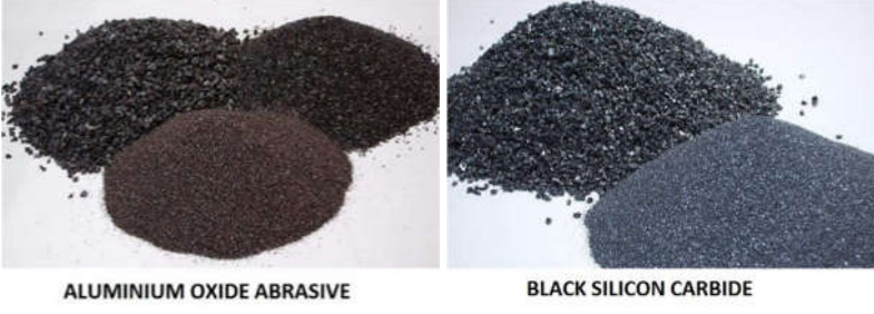
Şekil 4.3 Aşındırıcı Malzeme Örnekleri a) alüminyum oksit b) silisyum karbür
