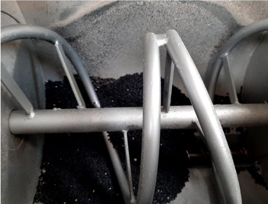
Şekil 3.3. Geri Dönüşüm Hattı Katkı Maddesi Besleme Ünitesi
