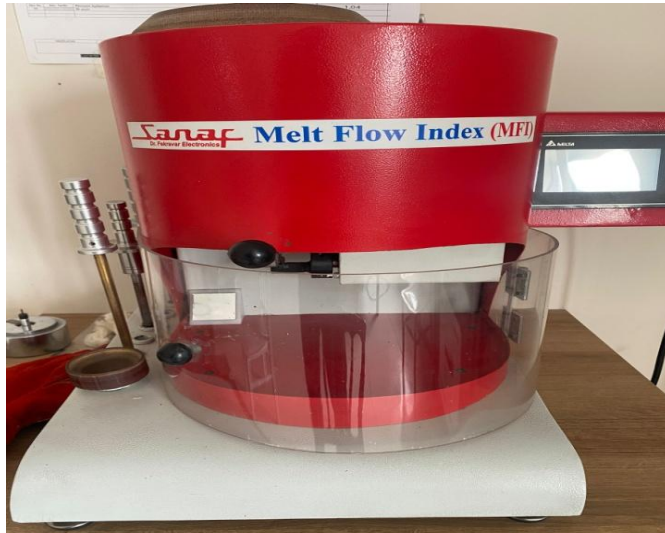
Şekil 4.8. Eriyik Akış İndeksi Testi (MFI)
