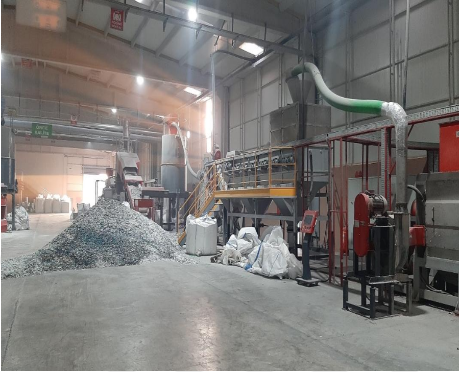
Şekil 3.2. Polipropilen (PP) Geri Dönüşüm Hattı
