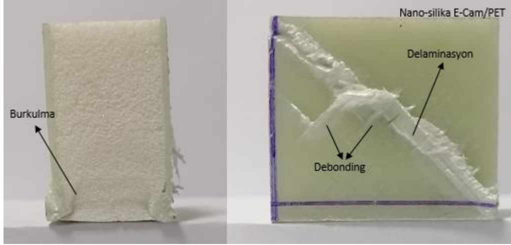
Şekil 4.9. Nano-silika katkılı E-Cam/PET sandviç kompozitlerin kenar basma deneyi neticesinde oluşan hasarların makro görüntüleri
