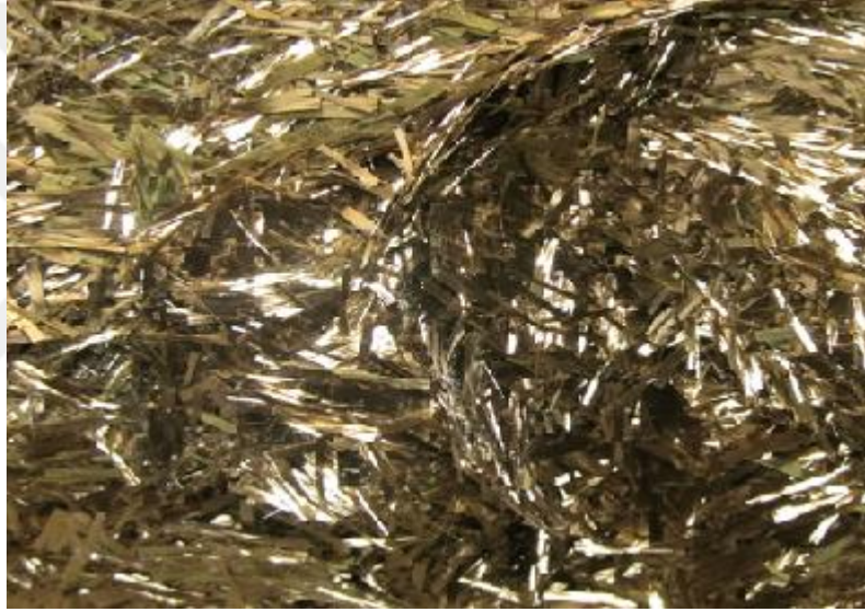
Şekil 2.7. Kırılmış bazalt elyaflar(Jalasutram ve ark., 2017).
