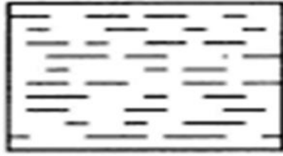
Kısa fiber veya whisker takviyeli kompozit (tek boyutlu düzen)
