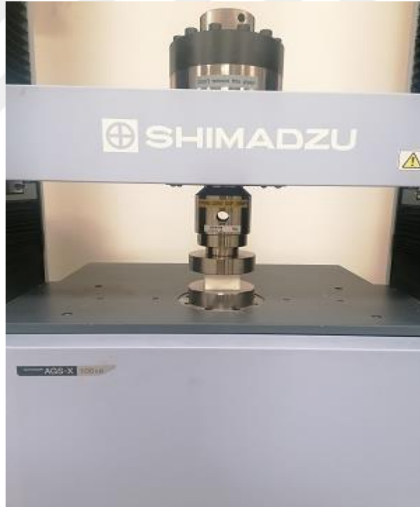
Şekil 3.7 Kompozit sandviçlere uygulanan düzlem basma testi
