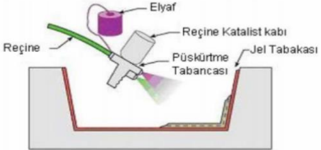
Şekil 2.9. Püskürtme yöntemi üretim aşaması(Akdoğan Eker, 2014)
