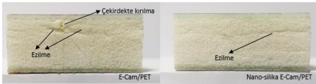
Şekil 4.10. Nano-silika katkılı ve katkısız E-Cam/PET sandviç kompozitlerin düzlem basma deneyi neticesinde oluşan hasarların makro görüntüleri
