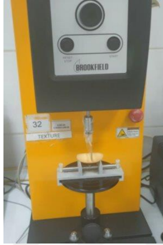
Şekil 3.3 : TexturePro CT3 cihazı ile tekstür analizi.
