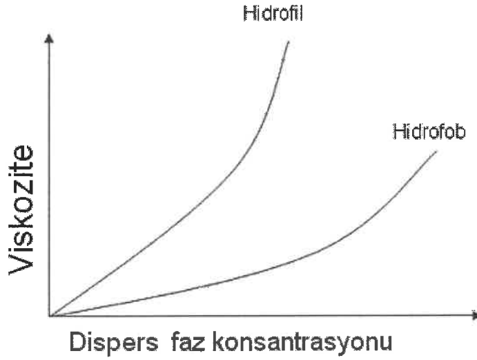
Şekil 2: Hidrofob ve hidrofil kolloidlerin dispers faz konsantrasyonunun viskoziteye etkisi
