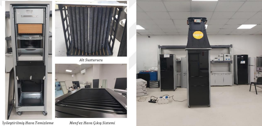
Şekil 5.23: Yeni Model a) Prototip Hazırlanması b) Testlerin Yapılması
