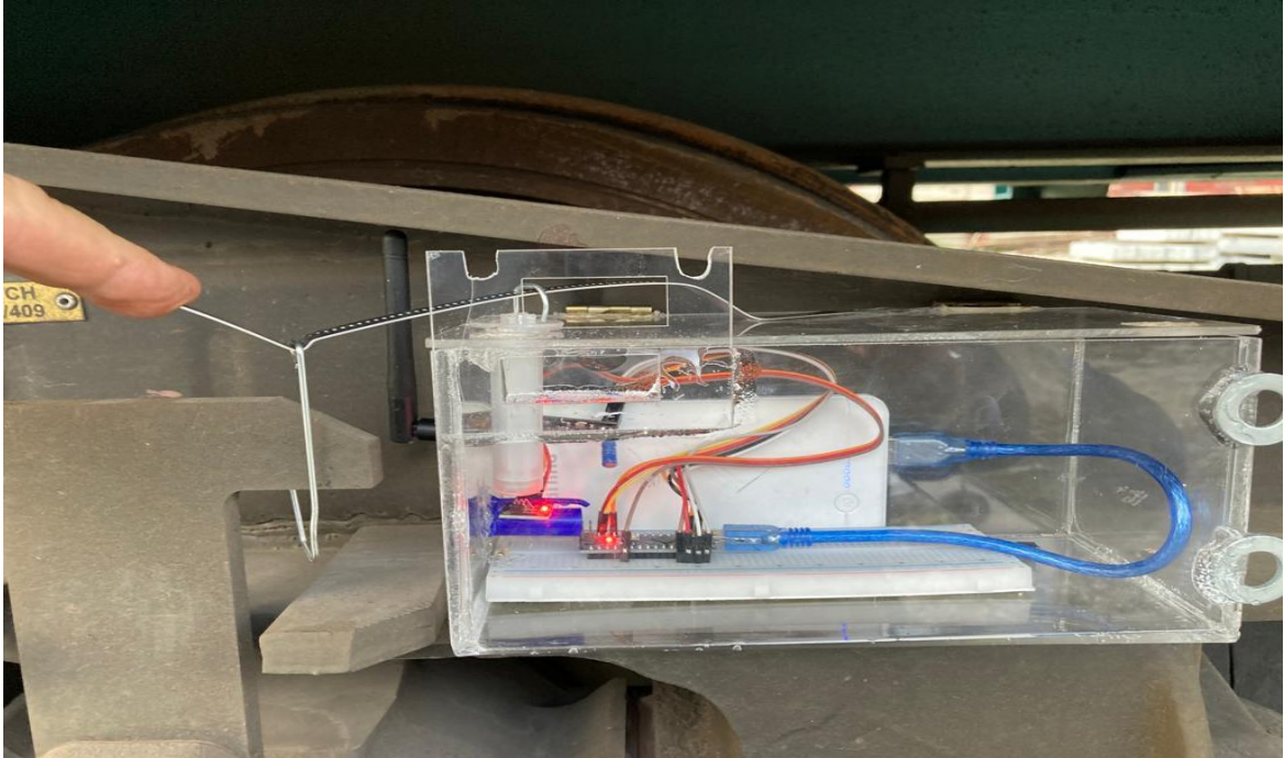
Resim 4.8. Deray tespit sisteminin çevresel faktörlerden etkilenmeden çalışmasının sağlanması
