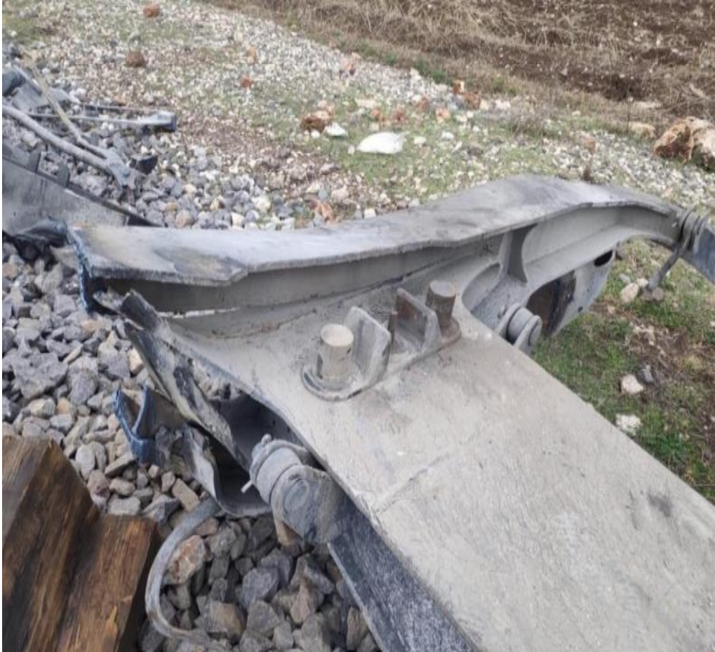
Resim 3.1. Deray sonucu kırılan boji (TCDD, 2021).
