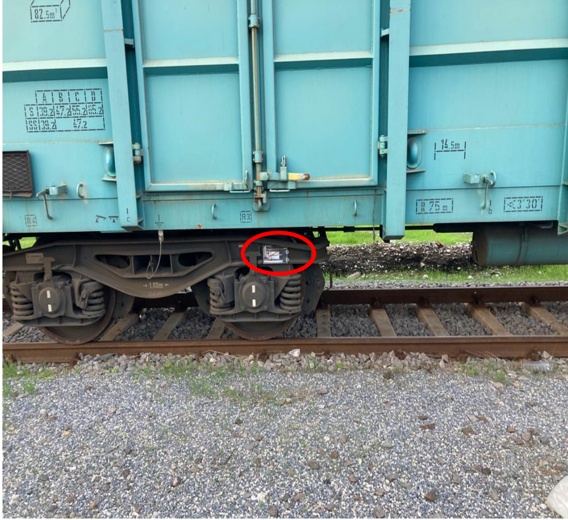
Resim 4.6. Deray tespit sisteminin vagon bodenine montajı
