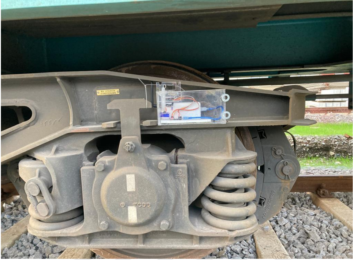
Resim 4.7. Deray tespit sisteminin vagon bodenine montajı (yakın plan)
