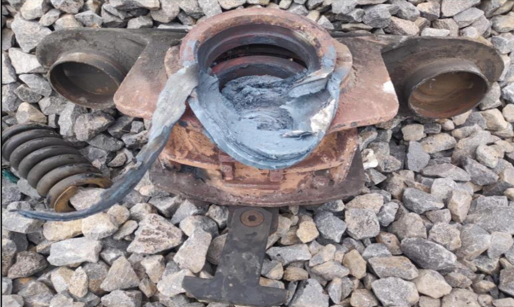
Resim 3.3. Deray öncesi ısınma sonucu düşen vagon süspansiyon yatağı (TCDD, 2021)
