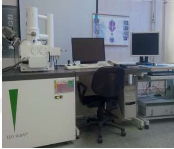
Şekil 43. Örneklerin SEM analizlerinin yapılmasında kullanılan cihaz
