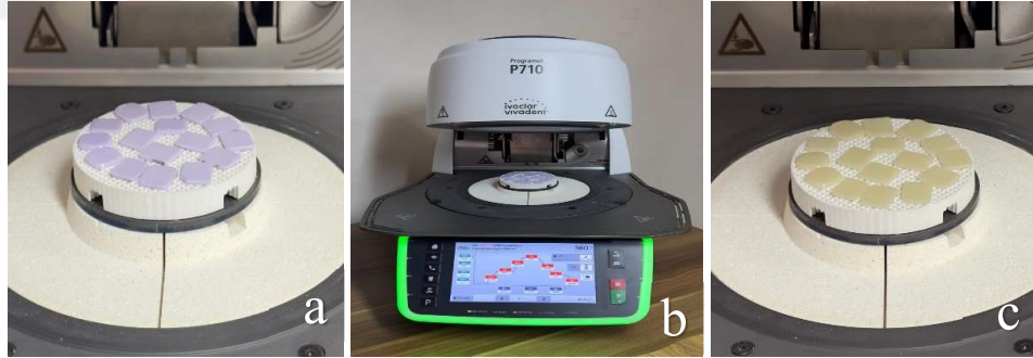
Şekil 12. a) IPS e-max CAD Örneklerinin Kristalize Edilmeden Önceki Görünümü b) İvoclar Vivadent Programat P710 Seramik Fırını c) IPS e-max CAD Örneklerinin Kristalizasyon Sonrası Görünümü
